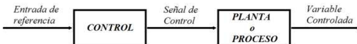
Figura 22: Diagrama de bloques de un sistema en lazo abierto
