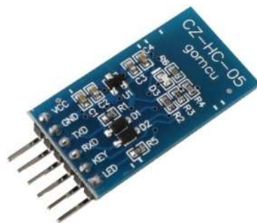
Figura 29: Módulo Bluetooth CZ-HC-05
