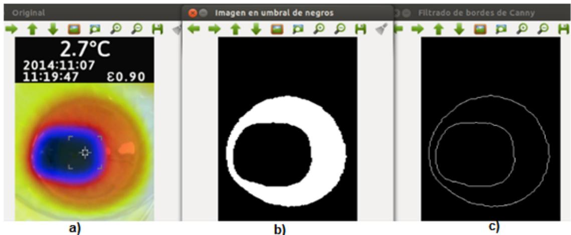
**Figura 47:** a) Imagen térmica vaso de agua congelada b) umbral de negro c) bordes detectados utilizando el algoritmo de Canny.
