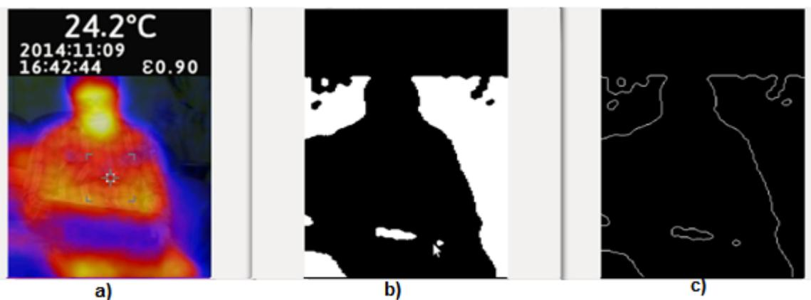
**Figura 51:** a) Imagen térmica corporal b) umbral de negro c) bordes detectados utilizando el algoritmo de Canny
