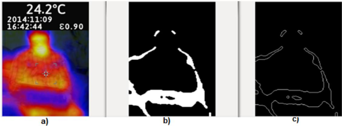
**Figura 52:** a) Imagen térmica corporal b) umbral de negro c) bordes detectados utilizando el algoritmo de Canny.
