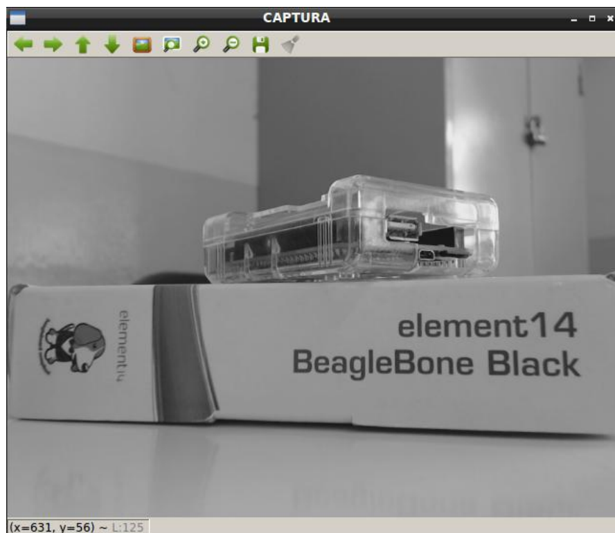
Figura 15: Lectura de una imagen utilizando Opencv, mediante la clase Mat en formato de pixeles GRAYSCALE.
