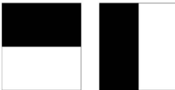
Figura 7: Funciones de Haar empleadas en el detector SURF.
