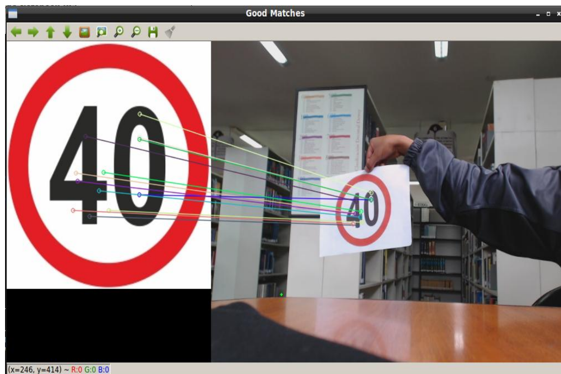
Figura 25: Resultado de búsqueda de señal de tránsito por medio del Algoritmo SURF.
