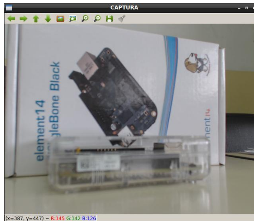
Figura 14: Lectura de una imagen con OpenCV, mediante la clase IplImage en formato de pixeles RGB.
