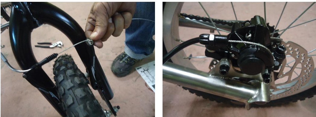
Figura 139: Montaje e instalación de los frenos en V delanteros y de disco traseros
