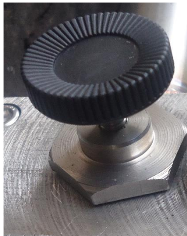
Figura 121: Perforación e implementación de sistema de enclavamiento
