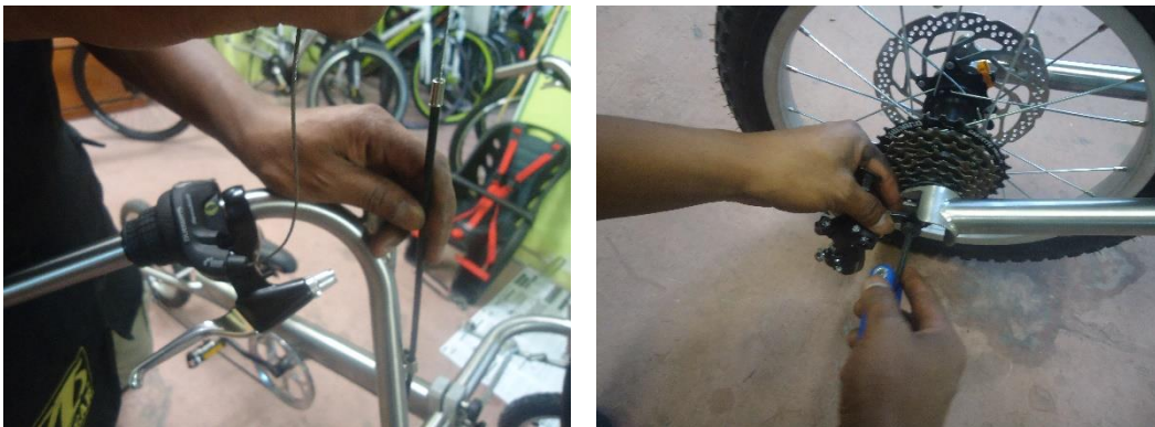
Figura 138: Montaje de la catarina trasera con su respectivo encarrilador
