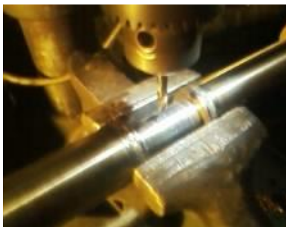
Figura 119: Perforación de bloque de aluminio
