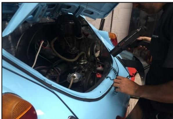
**Figura 107 Calibración del distribuidor**
