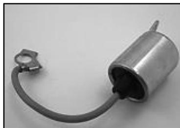
**Figura 57 Condensador**
