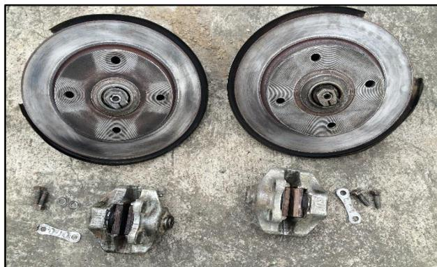
**Figura 81** Despiece del freno de disco
