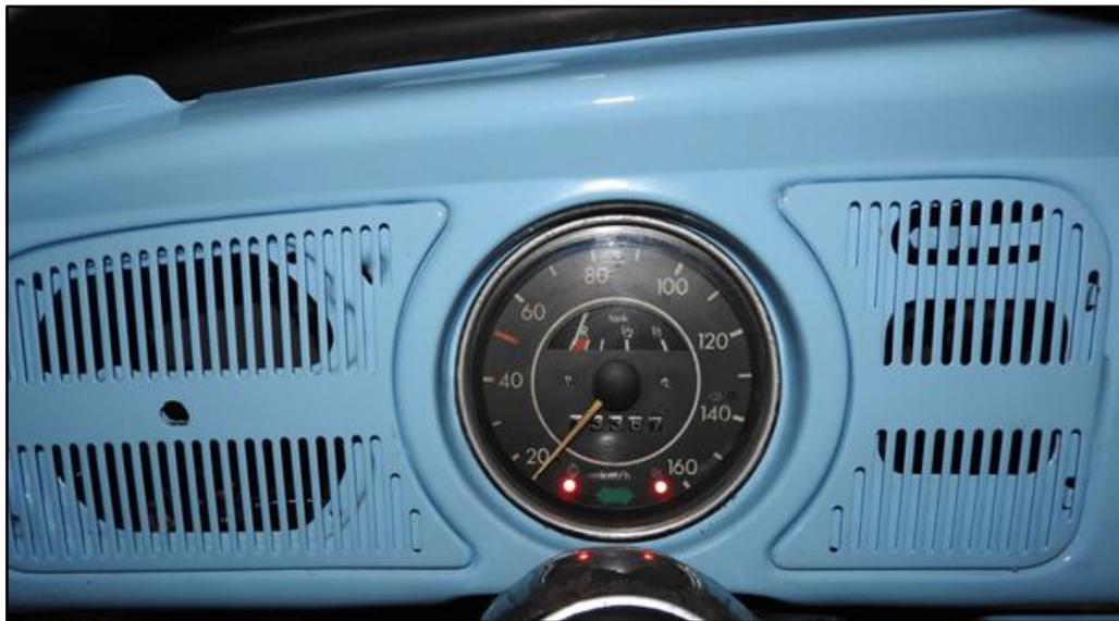
**Figura 114 Luces indicadora de aceite/alternador**
