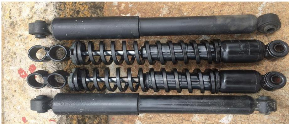
**Figura 112 Cambio de suspensión con espiral (carga nitrógeno/espiral)**
