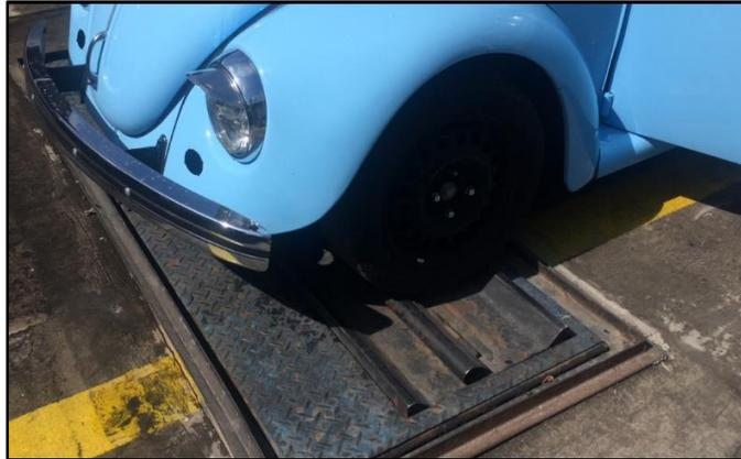
**Figura 108 Banco de vibración de suspensión Eje Delantero**
