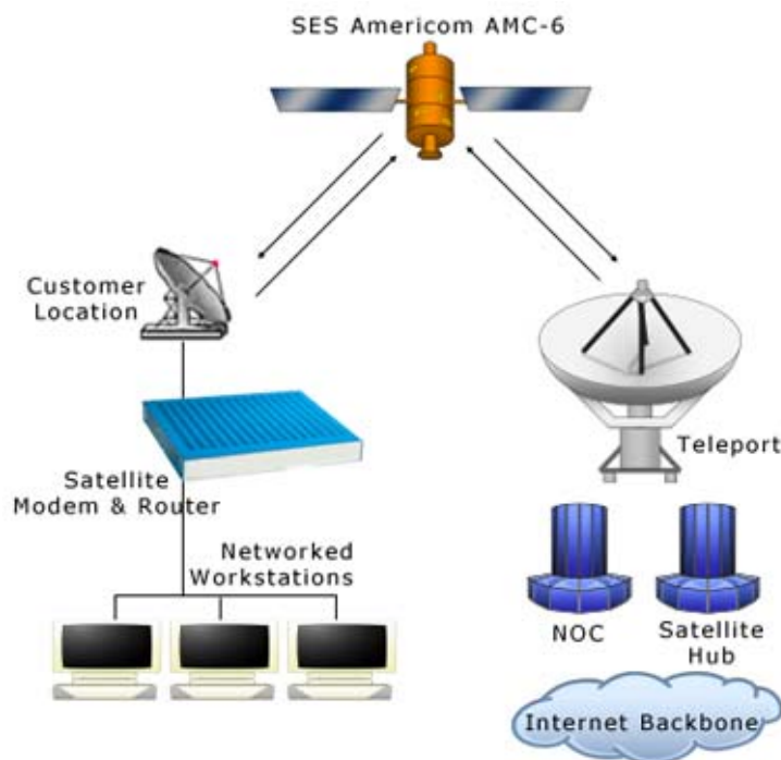
Figura. 2.1. Tipo de conexión vía satélite 1
