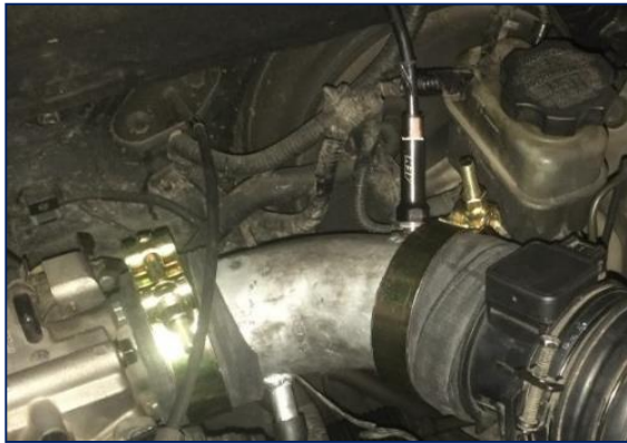
Figura 3 Implementación del conducto de admisión diseñado para la inyección de metanol
