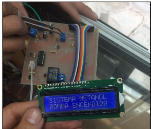
Figura 2 Comprobación del circuito alimentador de energía del sistema
