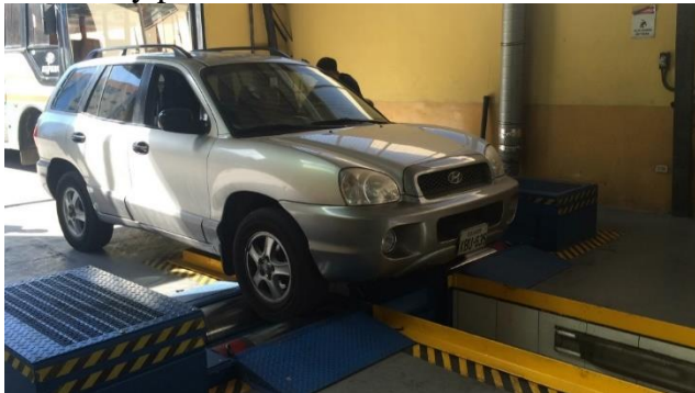
Figura 4 Evaluación de potencia en el dinamómetro de rodillos
