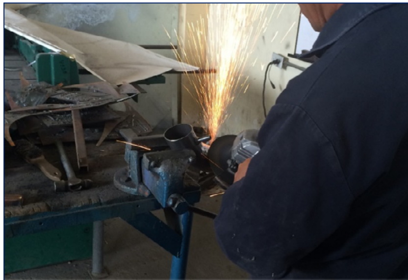
Figura 72 Cortes realizados en la tubería
