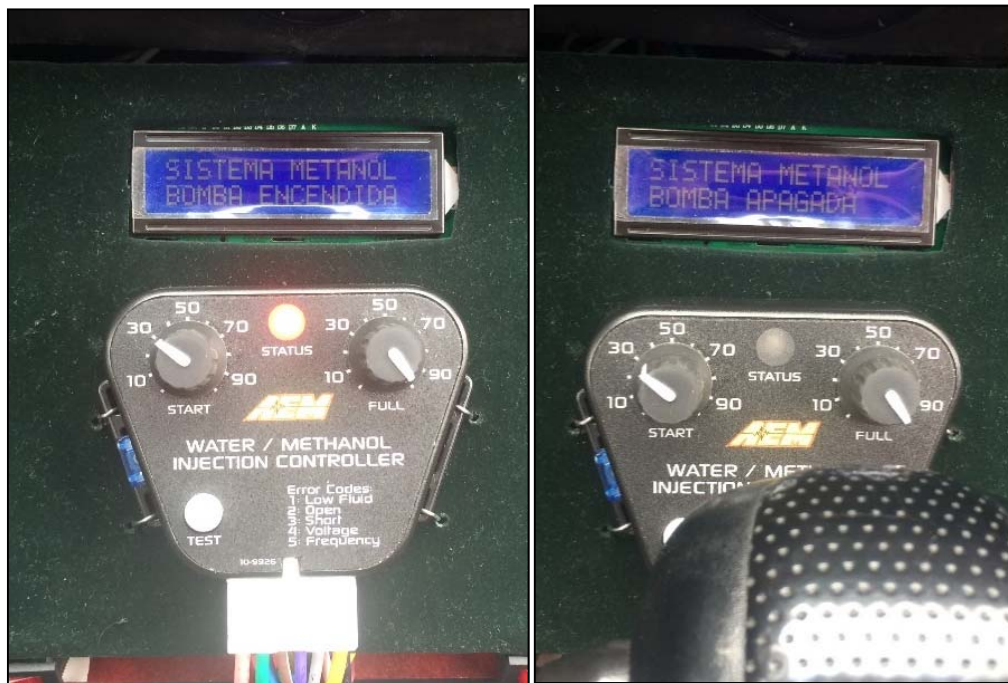
Figura 78 Comprobación de estados del circuito de control.
