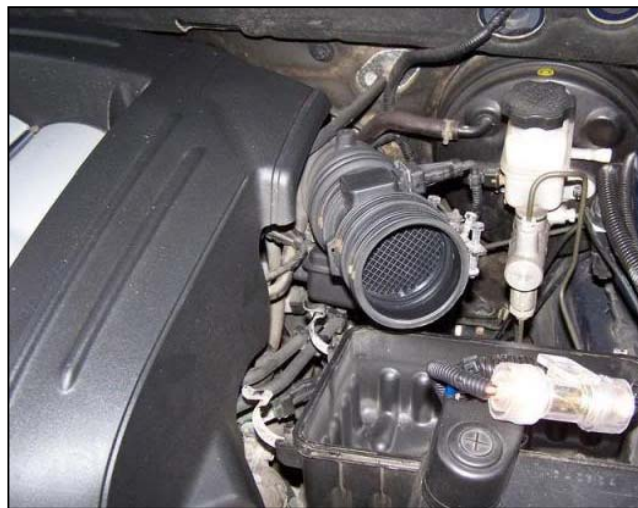
Figura 51 Espacio disponible para colocar el nuevo colector de admisión
