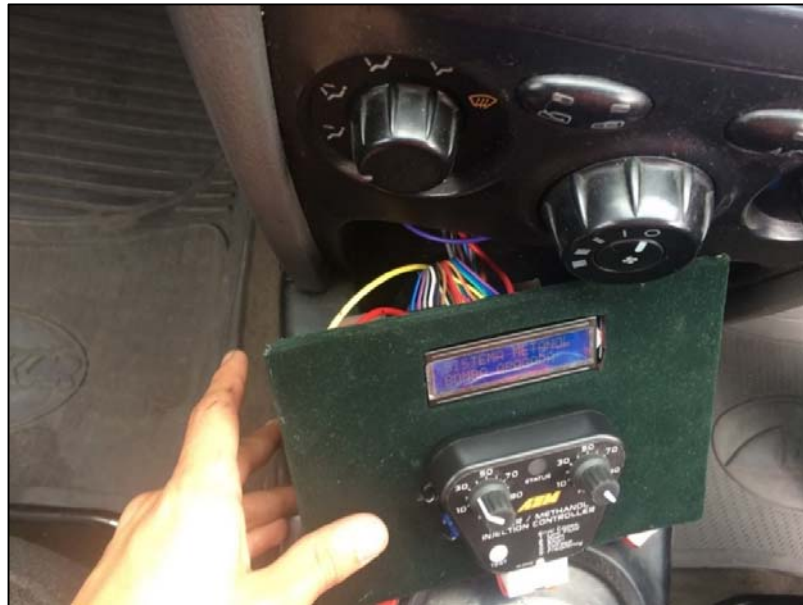
Figura 77 Implementación del sistema de control de inyección de metanol en el vehículo Hyundai Santa Fé 2.7 L
