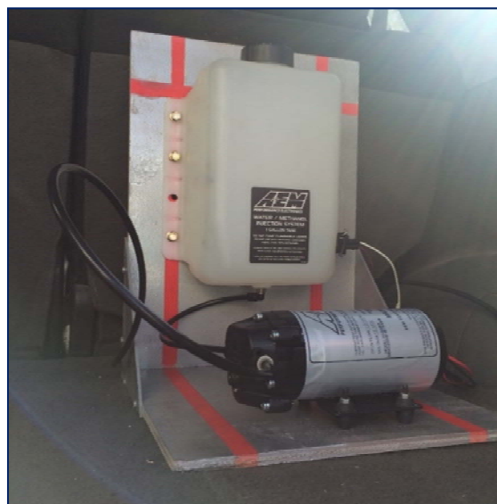
Figura 83 Bomba y depósito de metanol
