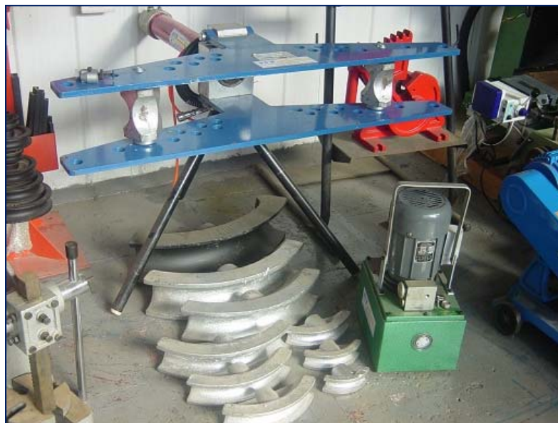
Figura 70 Dobladora de tubos
