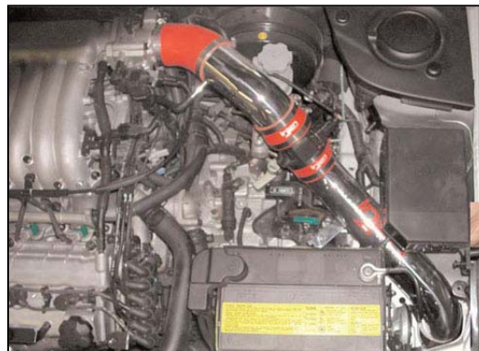
Figura 17 Conductos para aspiración de aire de aluminio
