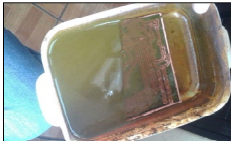
Figura 45 Proceso de elaboración del circuito de control (2 Corrosión del cobre restante)
