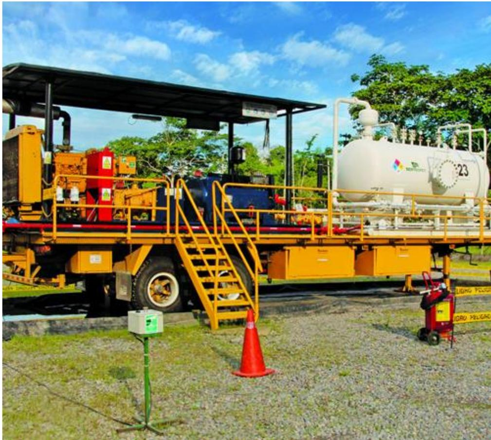
**Figura 5: Equipo de Superficie de Bombeo Hidráulico de Sertecpet (Sertecpet, s.f.)**
