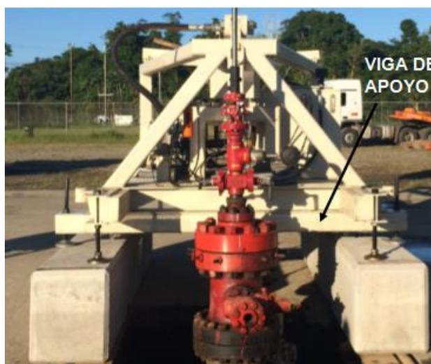
**Figura 45: A1 - Especificación de ubicación de viga de apoyo eliminada en el rediseño**
