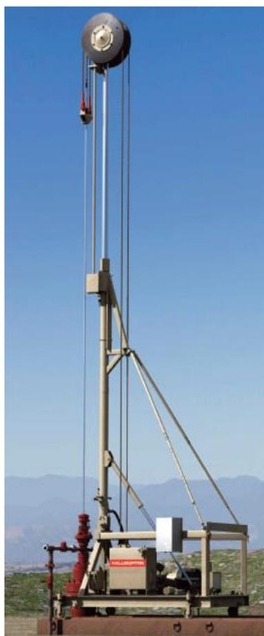
**Figura 2: Equipo de Bombeo Mecánico Halliburton**
