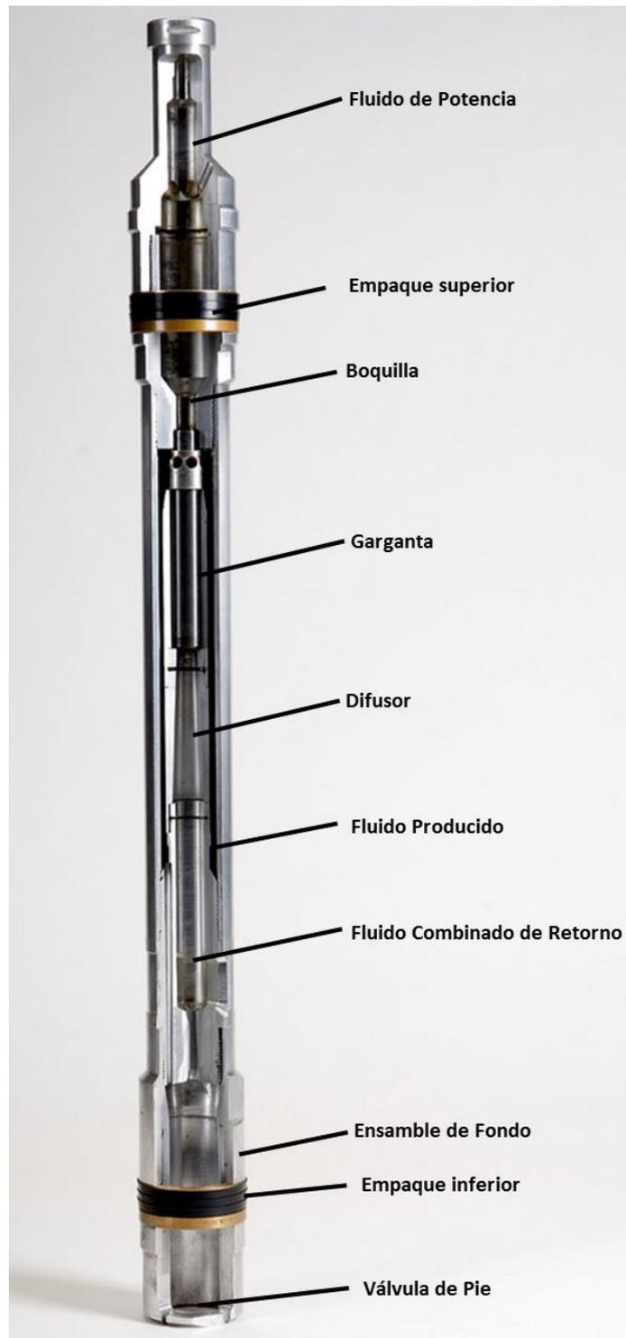
**Figura 4: Bomba Jet de Sertecpet (Sertecpet, s.f.)**
