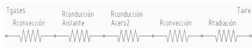
Figura 47 Pérdidas de calor en la tapa delantera
