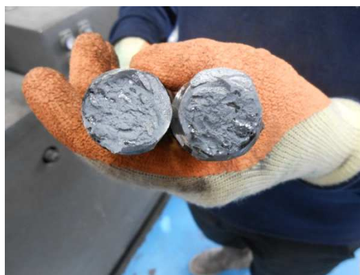
Figura 43 Ensayo de doblado junta soldada marca AL
