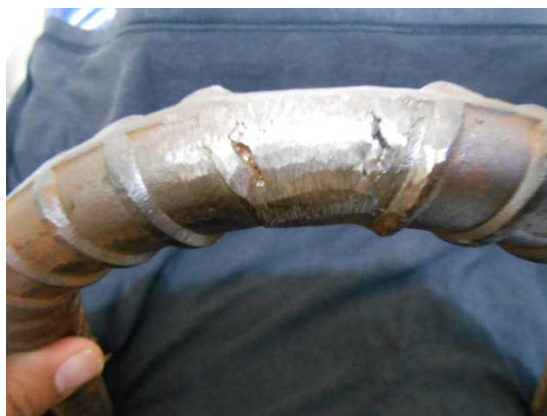
Figura 44: Ensayo de doblado junta soldada marca AL
