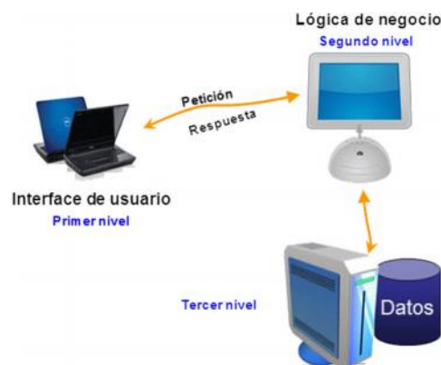
Figura 2.2 Arquitectura de tres capas
