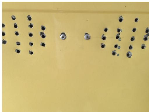
Figura 4.2.9: Perforaciones Ventiladores Laterales
