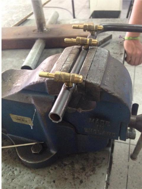
Figura 4.2.4: Corte Tubo de Distribución de Gas
