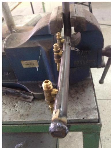
Figura 4.2.5: Adaptación Final Tubo Distribuidor de Gas
