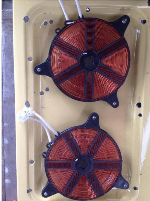
Figura 4.2.14: Montaje Bobinas de Inducción
