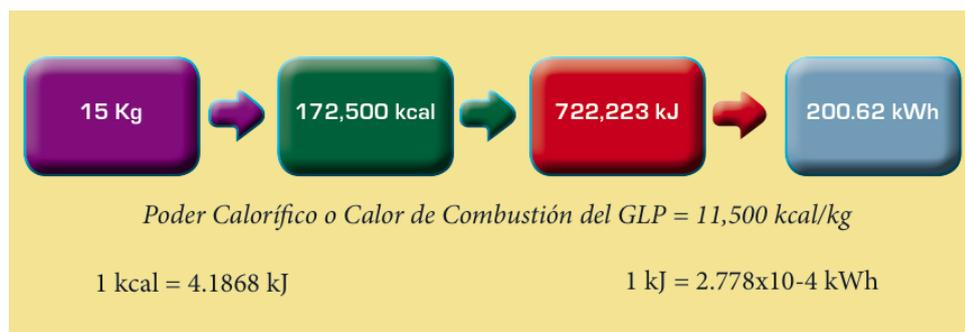
Figura 2.5.1: Equivalente Calorífico - Energético - Electricidad del GLP
