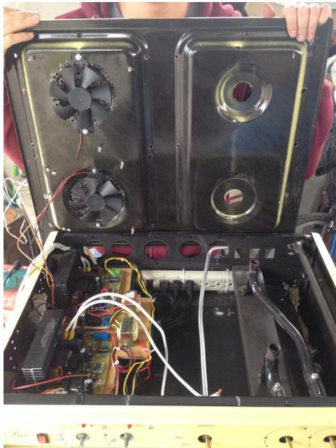
Figura 4.2.15: Componentes Gas-Inducción
