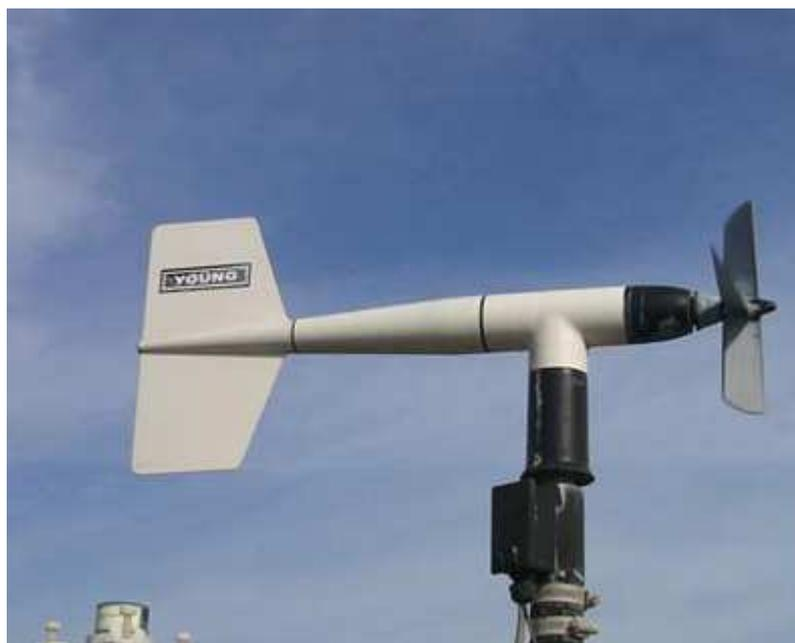
**Figura 3. Anemómetro de hélice**
