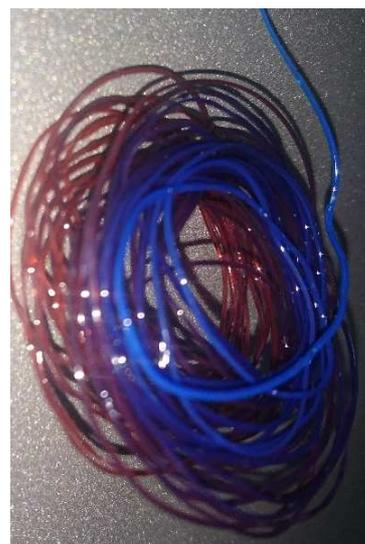
Figura 4.20: Resultados de transiciones de colores en extrusiones, con boquilla de 1mm de diámetro. Transiciones entre azul-transparente y azul-rojo.
