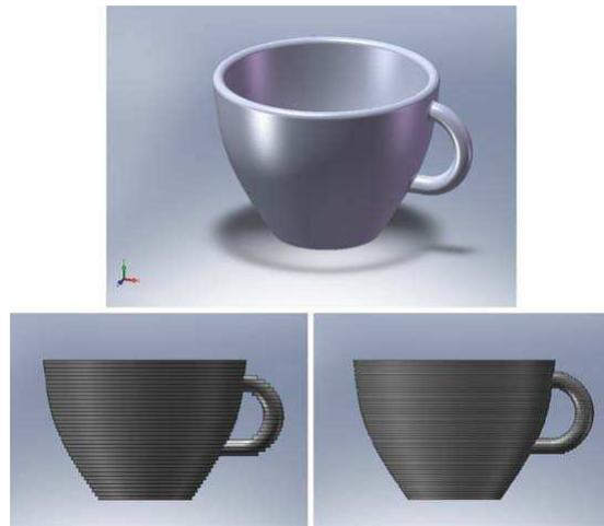
Figura 2.1: Modelado 3D de una tasa y se muestran los efectos de los diferentes tipos de espesor en cada capa.
