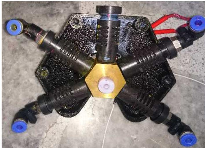
Figura 4.9: Extrusor ensamblado vista superior, antes de ser ensamblado en el robot.
