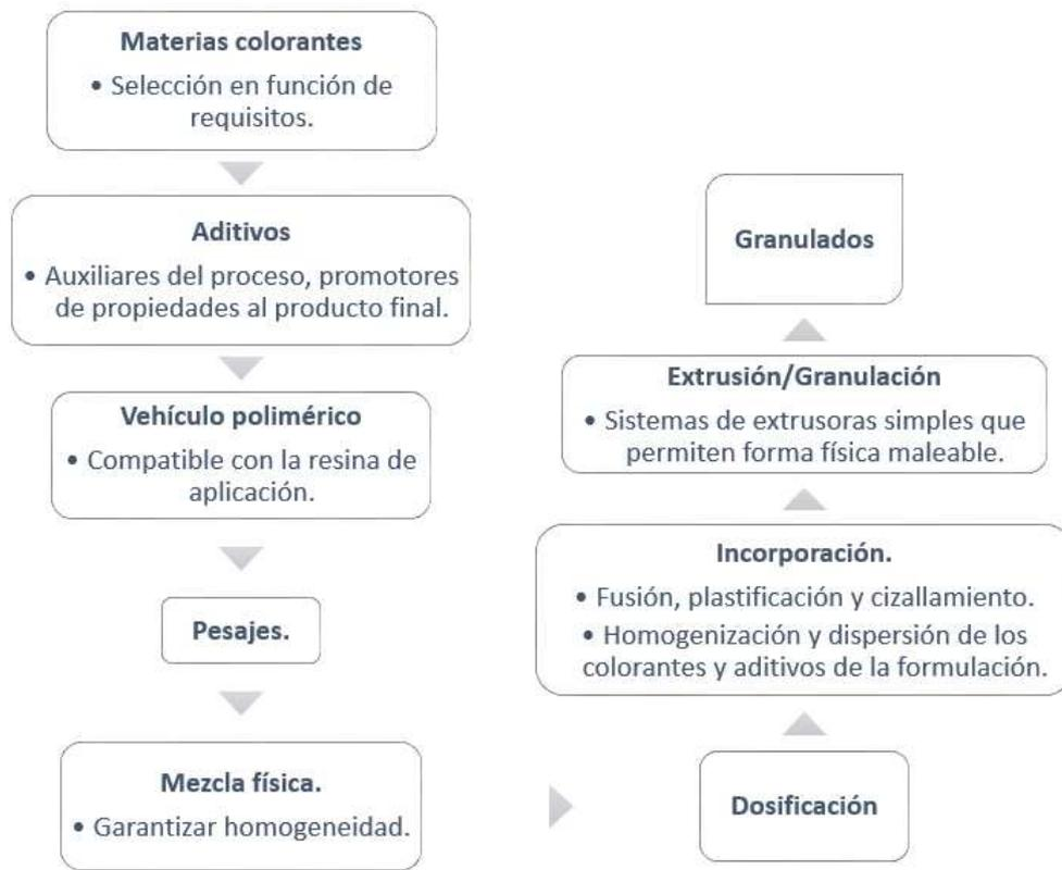
Figura 2.11: Esquema de fabricación de concentrados granulados.
