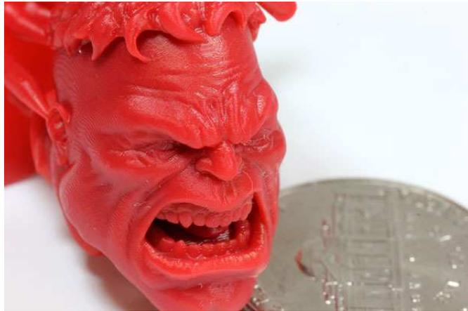
Figura 1.1: Ejemplo modelo 3D impreso por método FDM.
