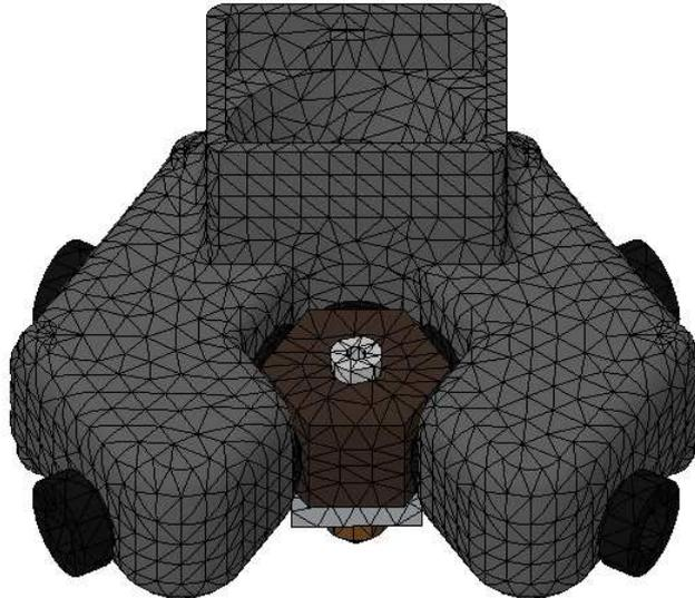
Figura 3.14: Discretización del extrusor para análisis térmico.
