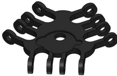
Figura 4.10: Plataforma para inclusión de actuador giratorio de empuje.
