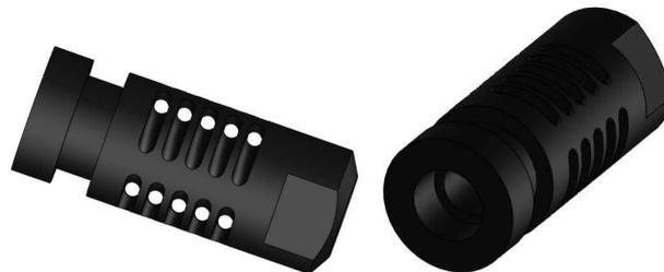
Figura 3.7: Modelado 3D del disipador, de material PEEK.
