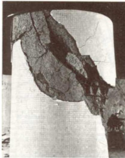
*Figura 3-18. Falla por tensión diagonal en columna zunchada*
