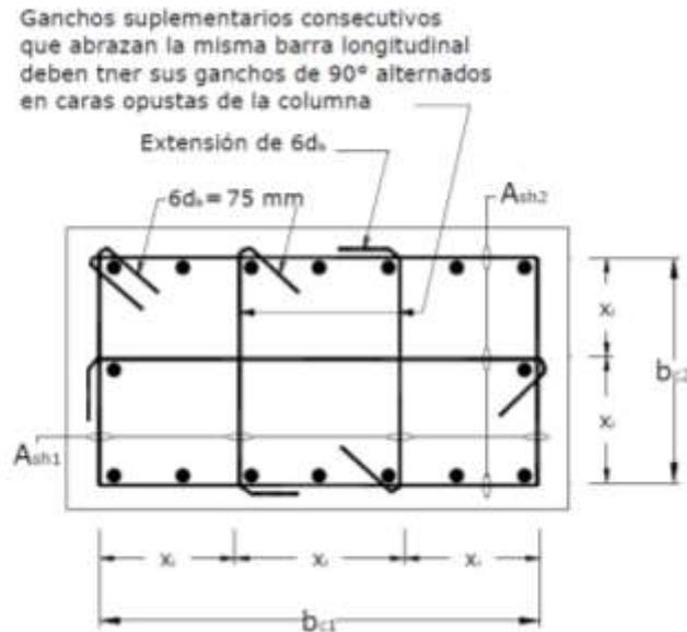
**Figura 15:** Ejemplo de refuerzo transversal en columnas.
