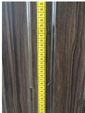
Figura 25. Medidor de presión
