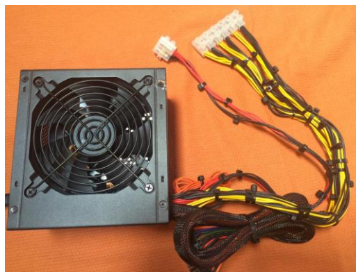
Figura 48. Convertidor de corriente AC a corriente DC
