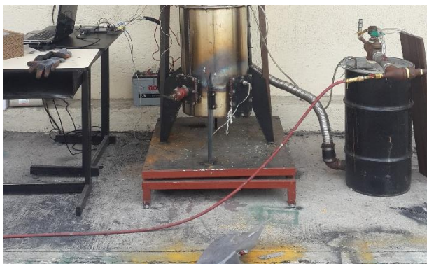
Figura 28. Conexión del aire al Venturi
