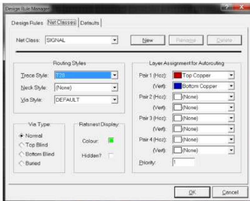
**FIGURA 41. Inserción de ancho de pistas para conexión en general (Ares)**
