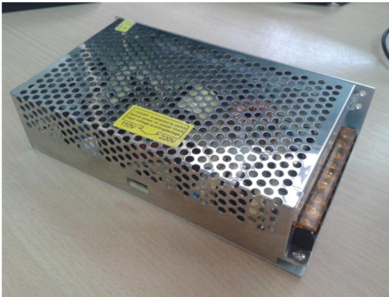
Figura: Fuente Conmutada 12V - 250W
