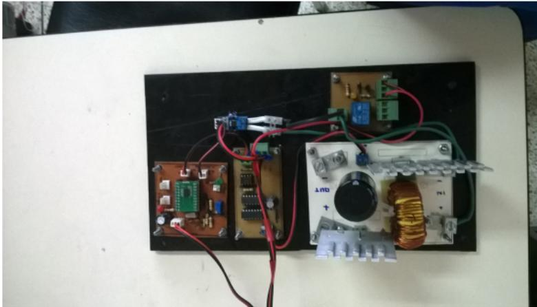
**Figura:** Implementación Física de Sistema de Carga por Freno Regenerativo
