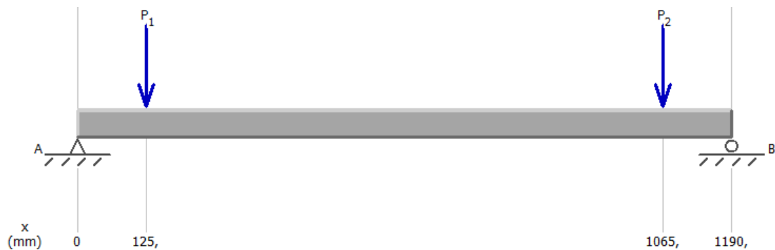
Figura 51. Diagrama de cuerpo libre del eje del rodillo de tinturado
