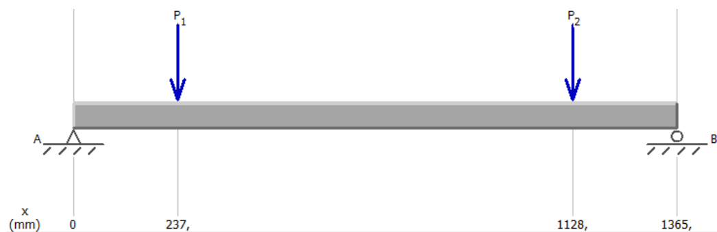
Figura 40. Diagrama de cuerpo libre del eje
