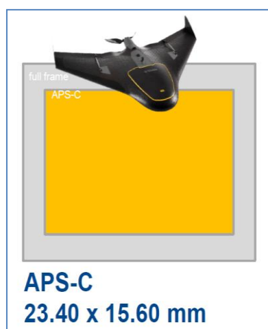
Figura 16. Tamaño del sensor de la cámara Sony NEX-5R. Fuente: (TRIMBLE, 2013)
