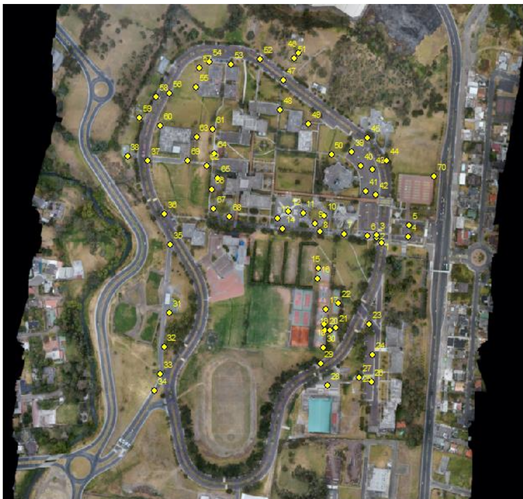
Figura 45. Distribución de los 70 puntos de validación sobre el mosaico ortorectificado.
