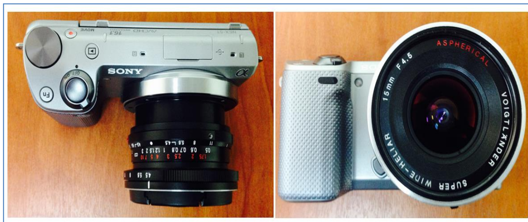
Figura 18. Cámara Sony NEX-5R con lente Voigtlander de 15 mm de longitud focal.
