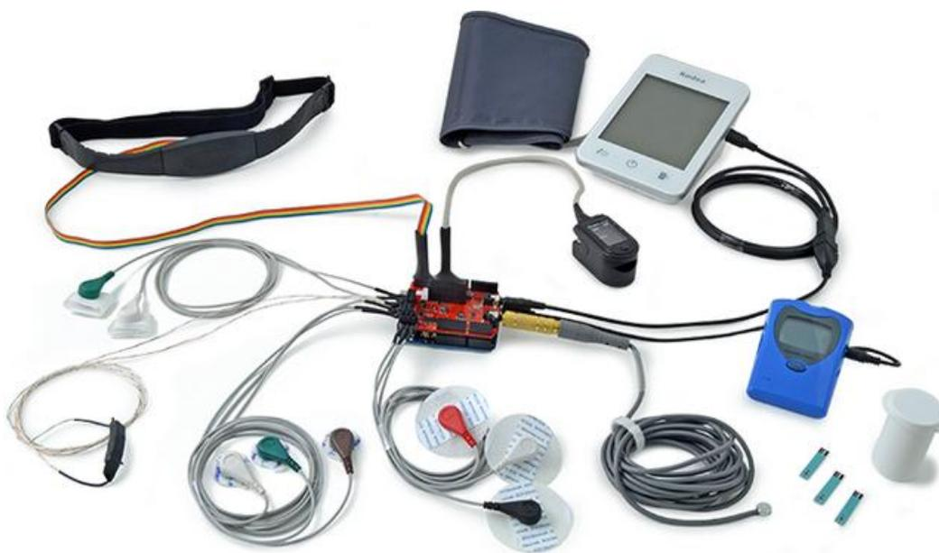
Figura 23. Escudo E-Health con sensores conectados
