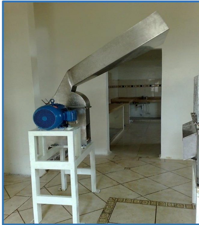
Figura 24. Molino de martillos
