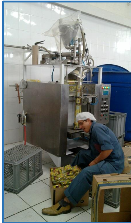
Figura 20 Máquina enfundadora con dosificador de líquidos
