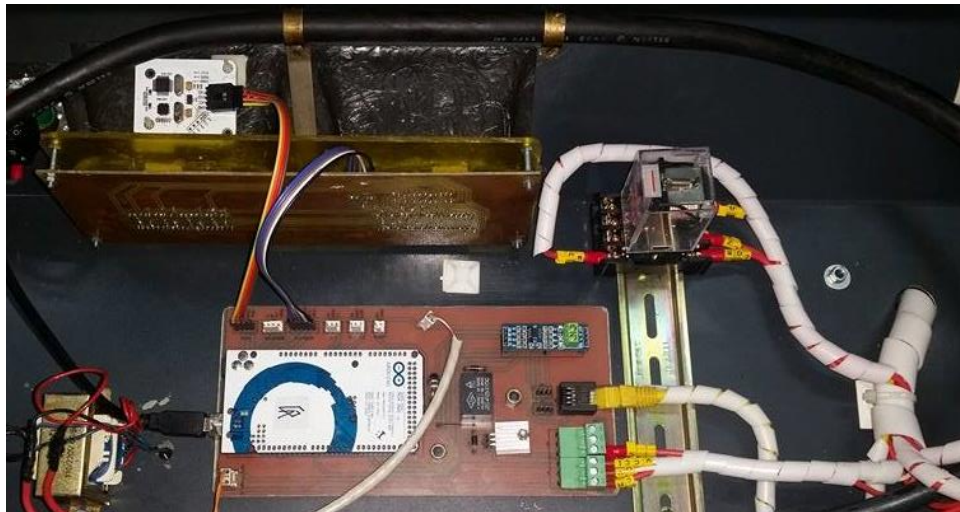
Figura 120. Arduino MEGA 2560 en la tarjeta de control.
