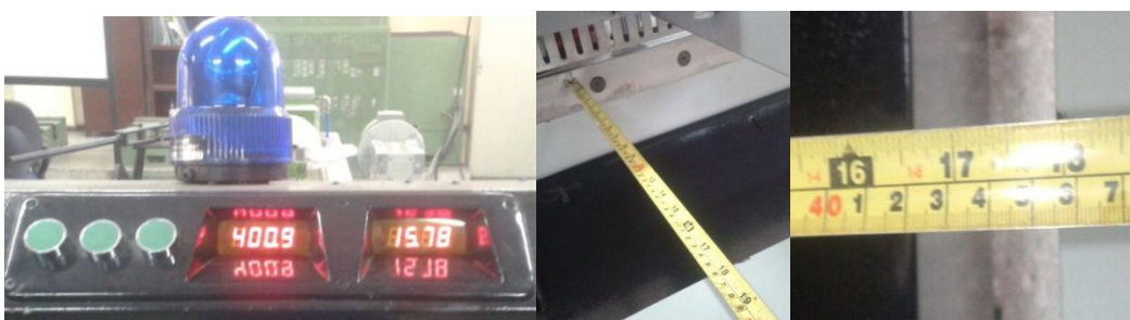
Figura 119. Longitud visualizada en los displays (errónea) con respecto a la que se midió con el flexómetro.
