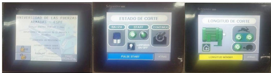
Figura 126. Ventanas del Touch – Panel.
