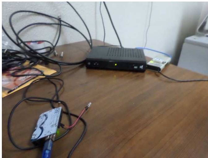
Figura 4.21: Tarjeta Arduino™ UNO R3 apuntando con IRLED hacia el STB.
