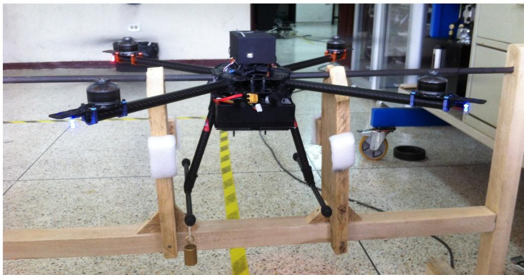
Figura 44: Prueba de Tiempo de Respuesta en Ejecución
