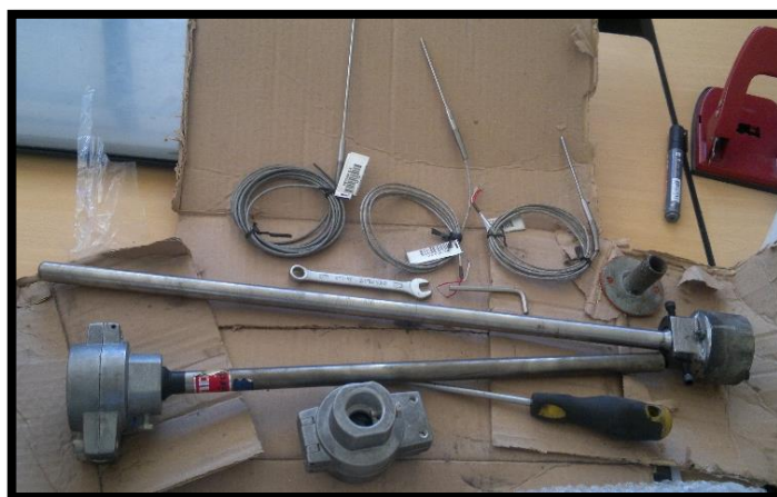
Figura No. 27 Instrumentación utilizada: Termocuplas tipo K / PT100
