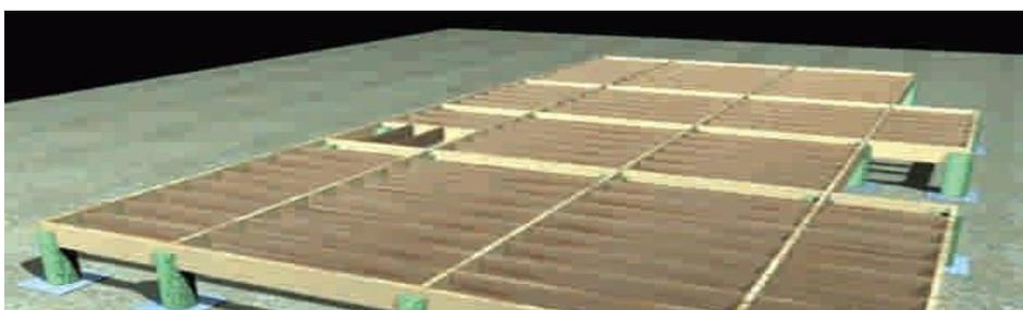
**Figura # 18:** Conjunto de vigas que forman plataforma de piso
