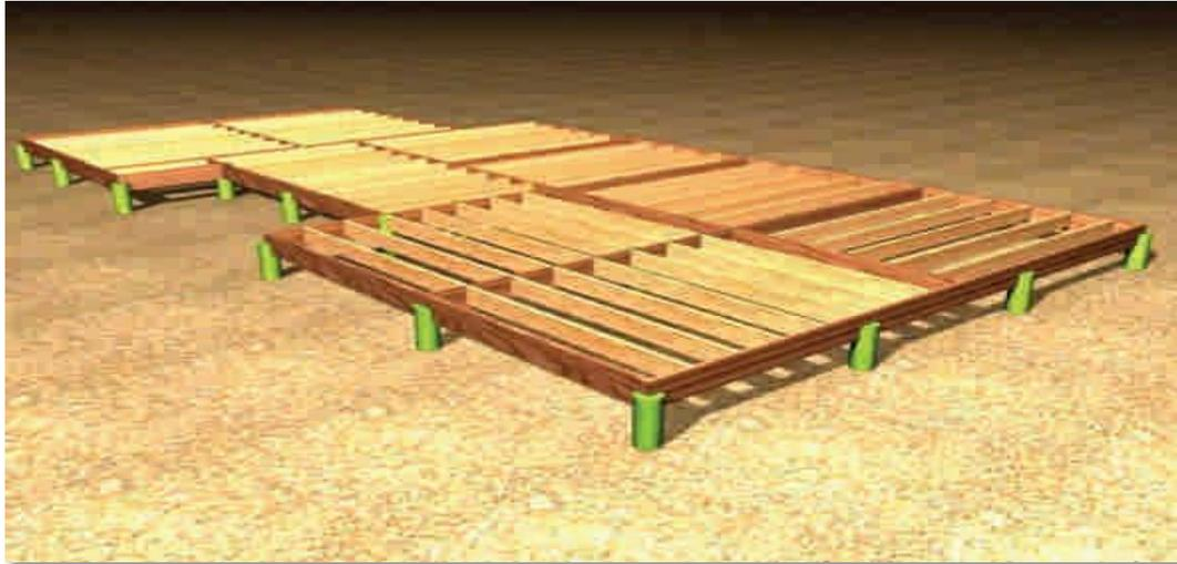
**Figura # 17:** Armado horizontal en piso
