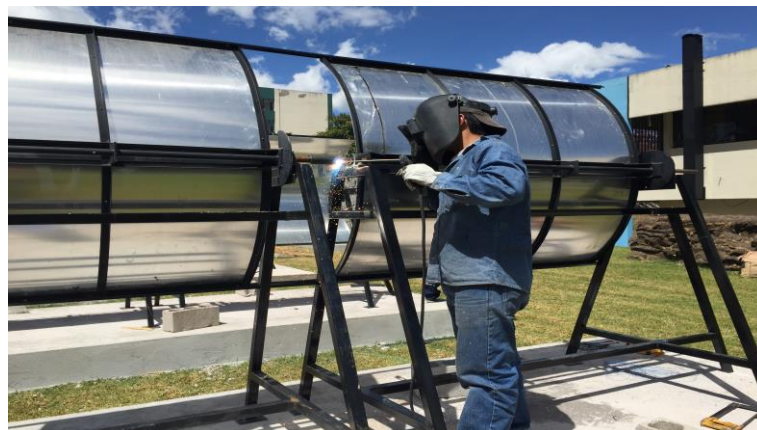
Figura 101. Soldado de la parte trasera del matrimonio.
