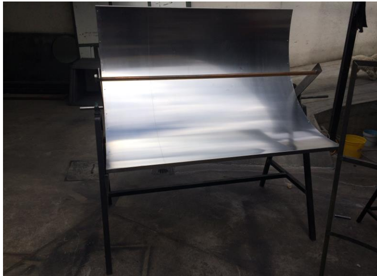
Figura 84. Doblado de 20 cm en los extremos de la lámina de aluminio.
