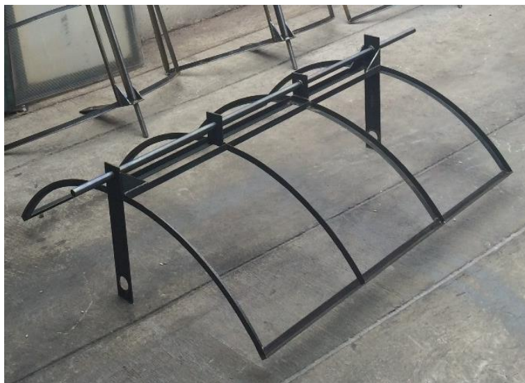
Figura 82. Soldadura de platinas y refuerzos de la estructura - parábola.
