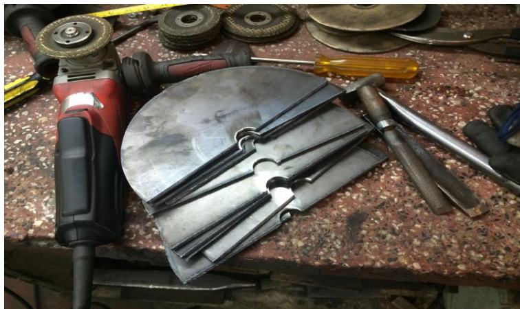
Figura 80. Cortado y Perforado de medias lunas de radio de 25 cm.
