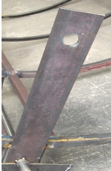
Figura 79. Cortado y Perforado de placas de medida 473 x 73 x 6 mm.
