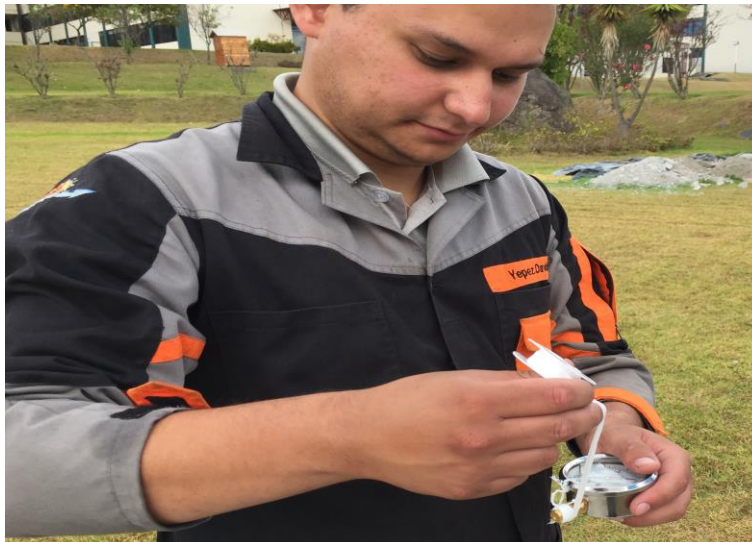
Figura 121. Sellado de los instrumentos de medición.
