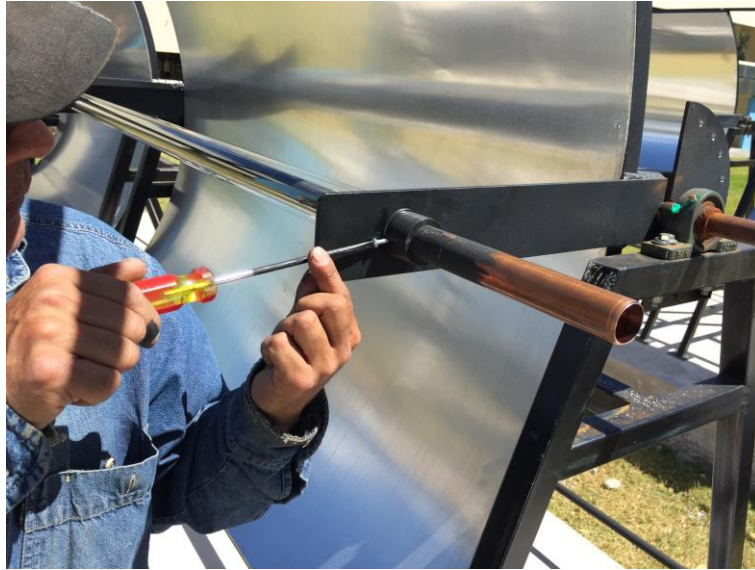
Figura 108. Sujetación de los acoples de grilón por medio de tornillos.
