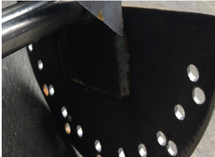
Figura 81. Perforación de agujeros de 10 mm de diámetro cada 15°.
