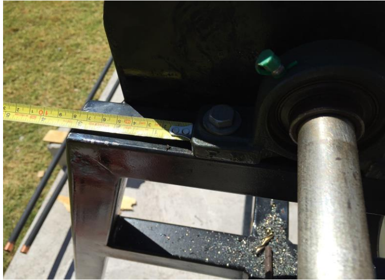
Figura 96. Centrado se la chumacera con respecto a la estructura base.
