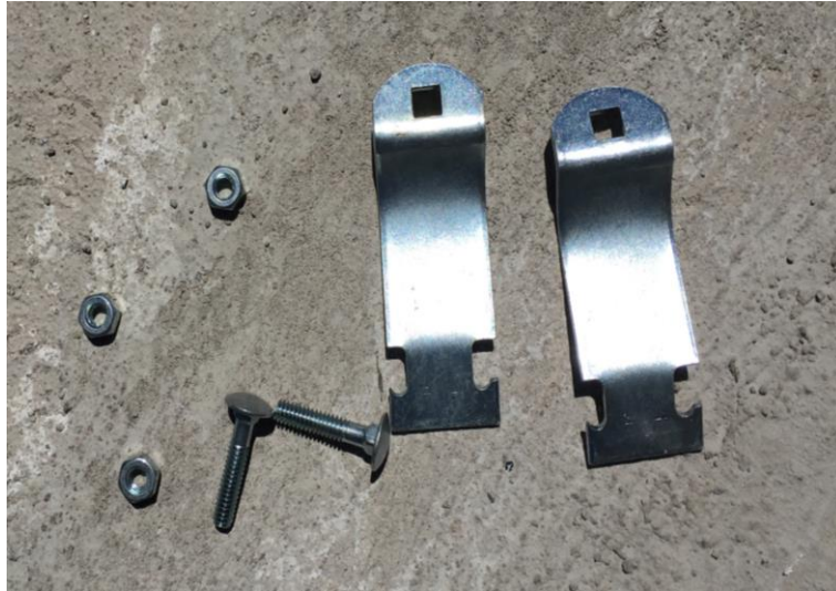
Figura 112. Doblado de platinas.
