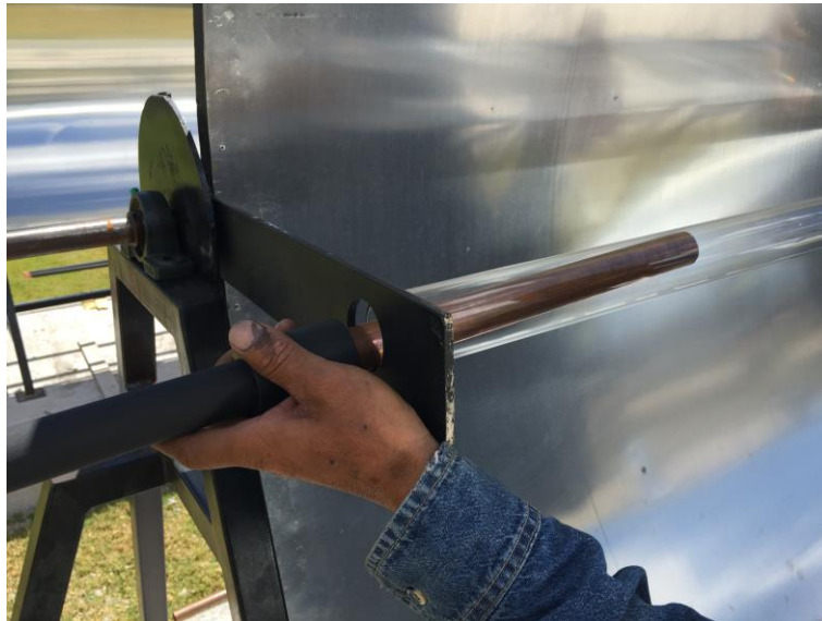
Figura 106. Ingreso del tubo de cobre sobre al tubo de vidrio.
