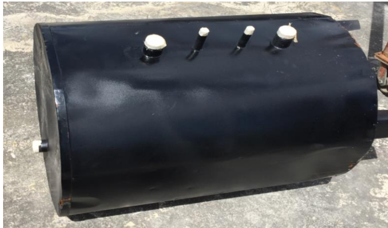
Figura 85. Perforación de las aberturas de entrada y salida del tanque.
