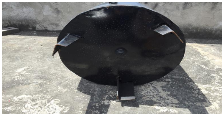
Figura 86. Soldadura de las patas del reservorio de aceite.
