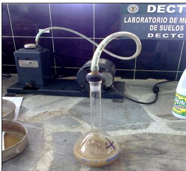
Figura 22. Picnómetro con suelo arcilloso Canal San Antonio
