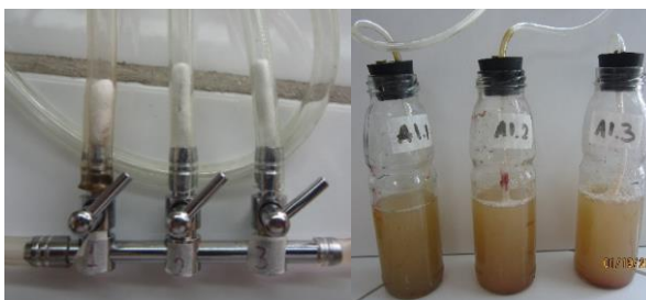
Figura 2.13: Montaje del tratamiento de aireación
