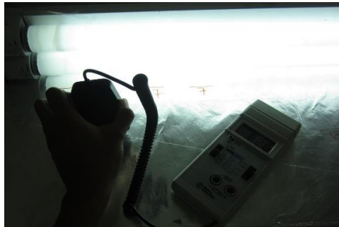
Figura 2.12: Uso de luxómetro para medir la iluminancia
