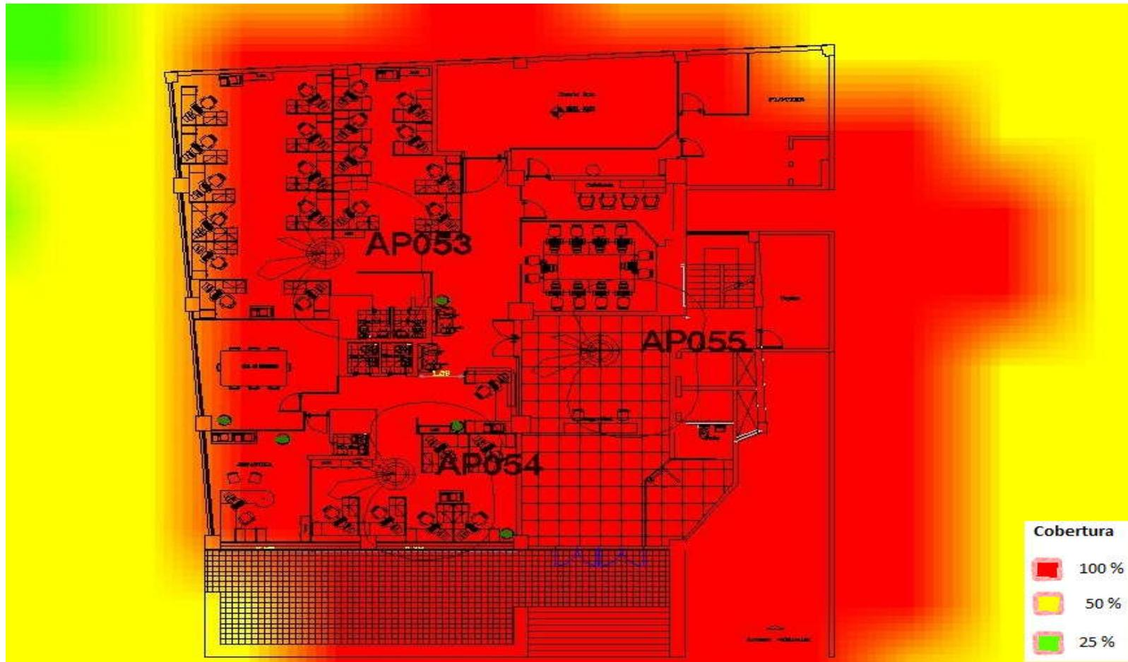
**Figura 5. Diagrama Físico de dispositivos Inalámbricos Propuestos para el Edificio ALPALLANA**
