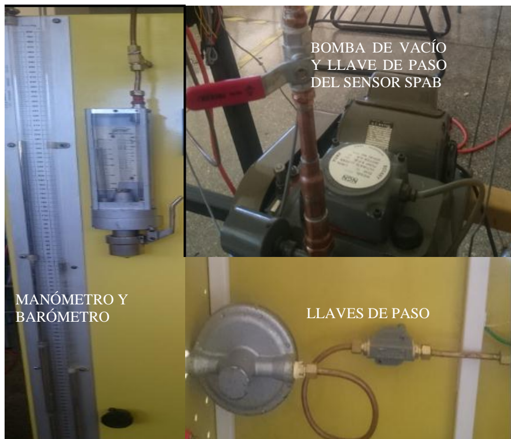
Figura 67 Verificación de Componentes Mecánicos del Equipo TE.85
