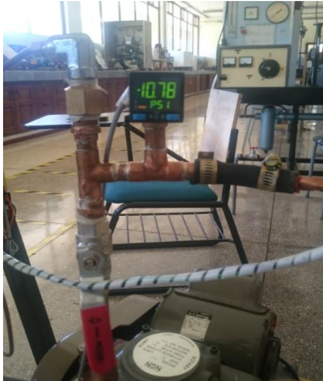
Figura 72 Medición de Presión con Sensor SPAB después de 1 hora
