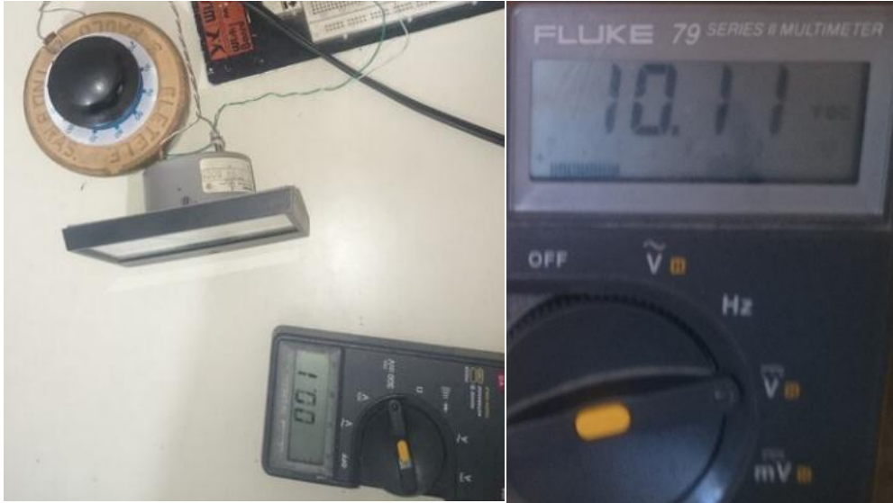
Figura 65 Verificación de las Tensiones de Entrada y Salida del Sistema Electrónico
