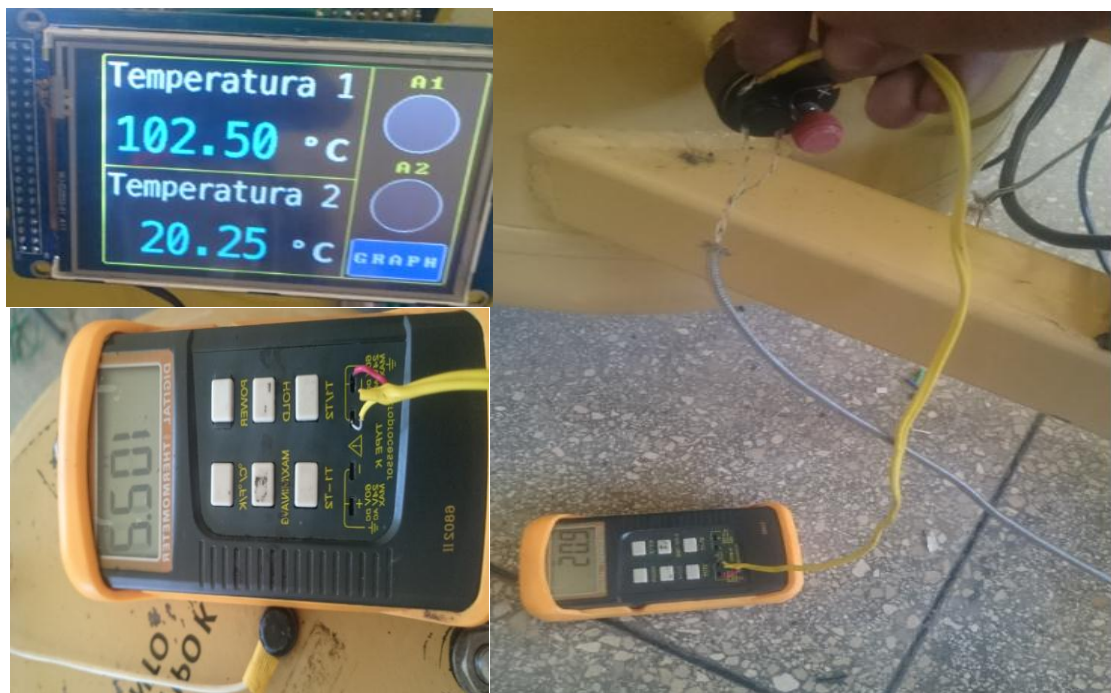
Figura 70 Verificación de la Medición de la Temperatura de la Termocupla del Elemento y Contenedor del Equipo TE.85
