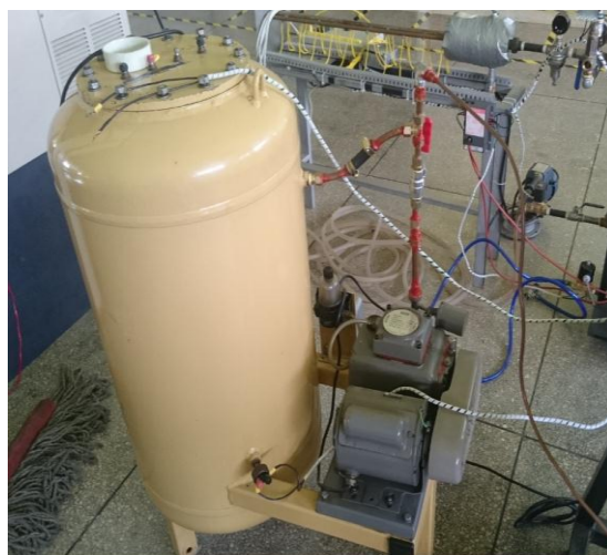
Figura 13 Contenedor de acero, Bomba de Vacío y Conexión de Tuberías
