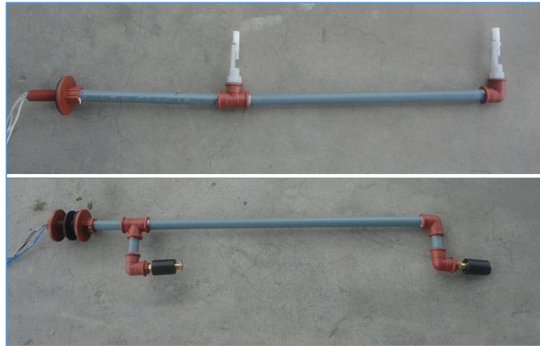
Figura 4-8 Estructuras armadas para los sensores de nivel de los tanques
