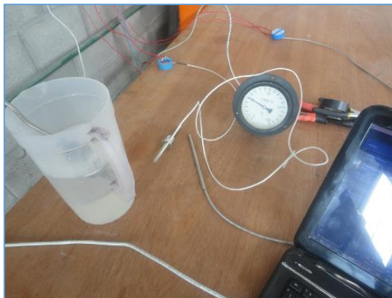
Figura 5-2 Verificación de los sensores y transmisores de temperatura
