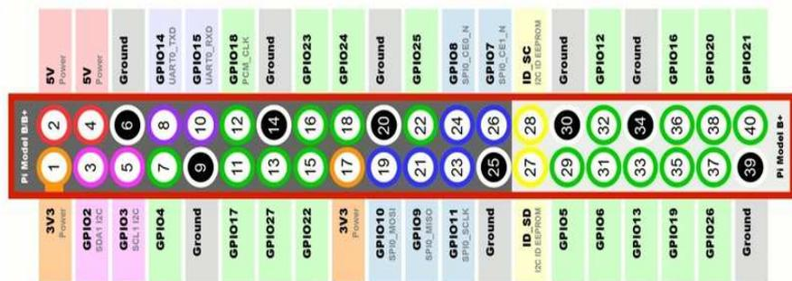
Figura 13 General Purpose Entrada/Salida GIO, fuente (PE, 2014)
