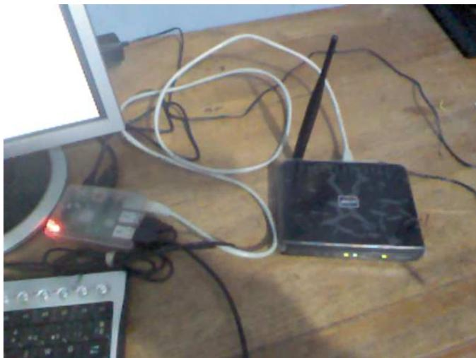
Figura 67 Implementación de la red Raspberry a medio Wireless
