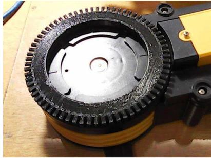
Figura 44 Encoder Impreso junto a la base de la estructura
