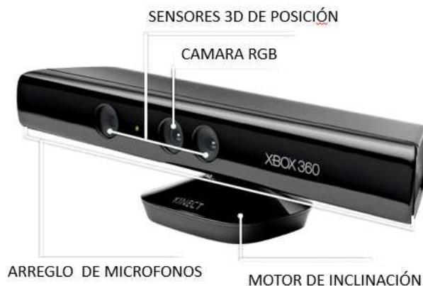
Figura 8 Distribución de sensores y actuadores en Kinect, fuente propia
