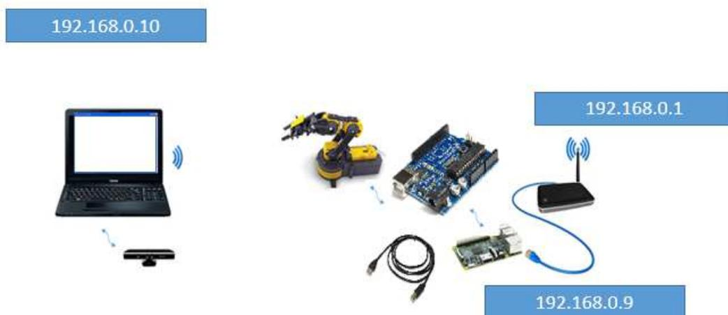
Figura 35 Esquema de Red, Dirección Ip de cada equipo
