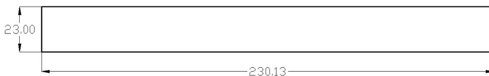
**Figura 107. Tapa protectora para las celdas Braille (dimensiones en milímetros)**
