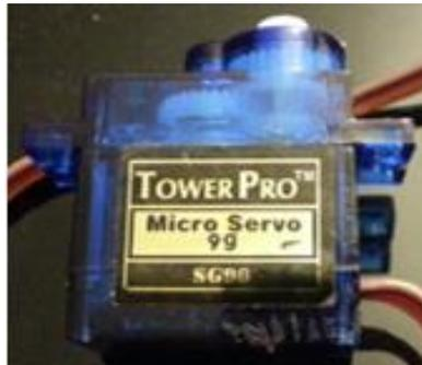
**Figura 137. Servomotor TowerPro SG90**
