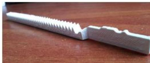
**Figura 124. Cremallera fabricada con impresión 3D**
