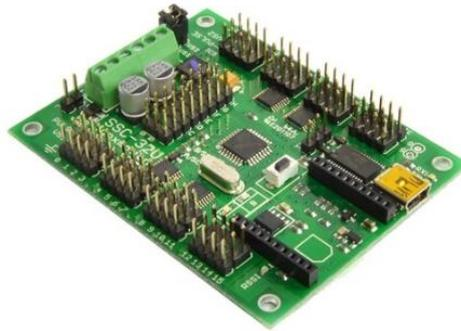
**Figura 136. Controlador para servomotores SSC-32U**
