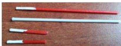
**Figura 125. Pines fabricados con impresión 3D**
