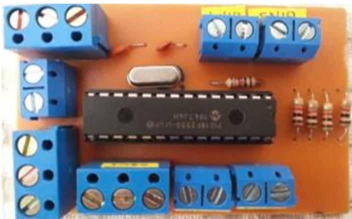
**Figura 134. Vista superior del circuito implementado**
