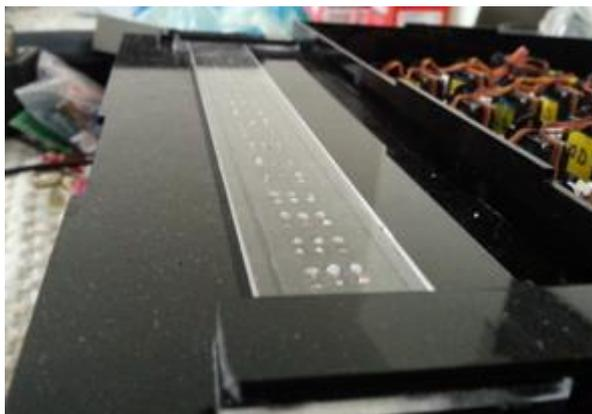
**Figura 131. Tapa de protección para las celdas Braille acoplada a la segunda tapa superior**
