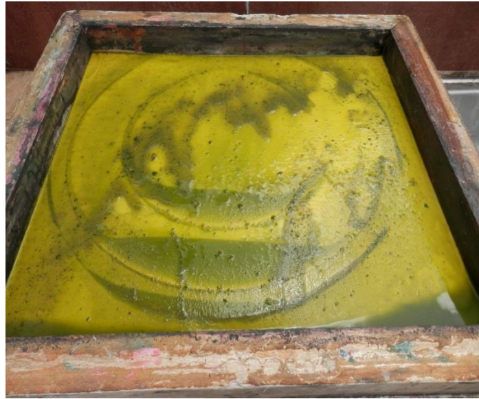
Figura 2.7 Separación de medio líquido y sólidos (biomasa de Chlorella sp.) mediante un tamiz.
