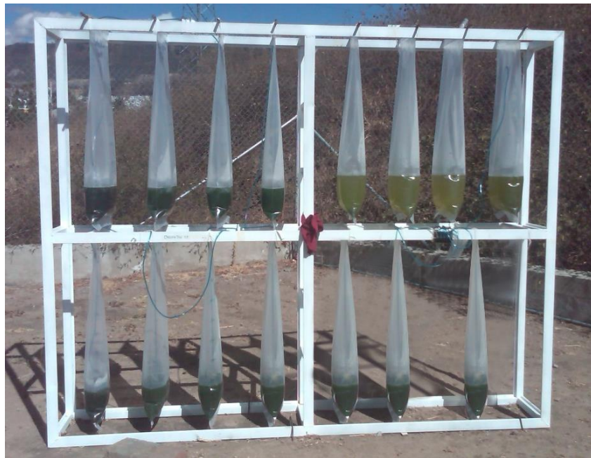
Figura 2.8 Etapa 2, estrés nutricional de nitrógeno, fotobioreactores de 2 L de capacidad, colocados al azar.
