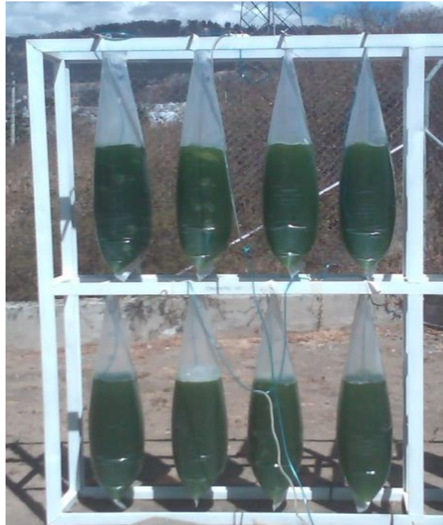
Figura 2.6 Escalamiento del cultivo de Chlorella sp. a fotobioreactores de 15 L c/u.
