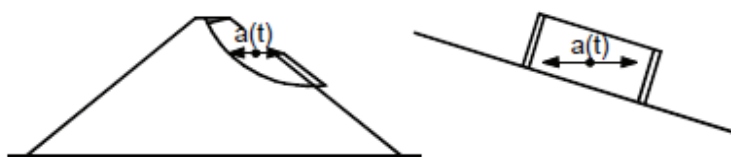
Figure 2.10 : Desplazamientos en taludes sujetos a carga sísmica.
