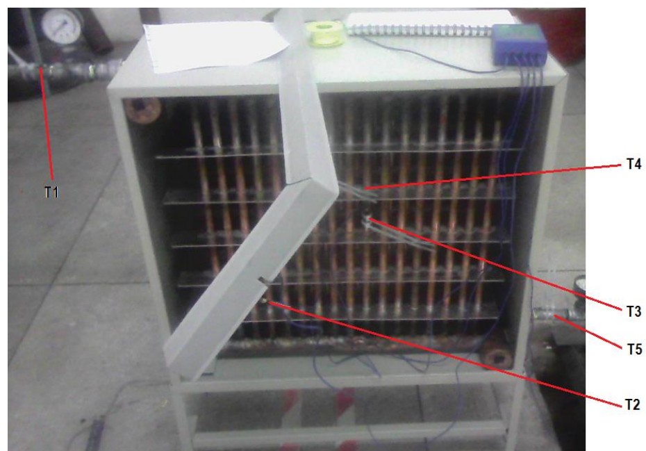
Figura 4.10. Ubicación de los puntos para medición de temperatura en intercambiador
