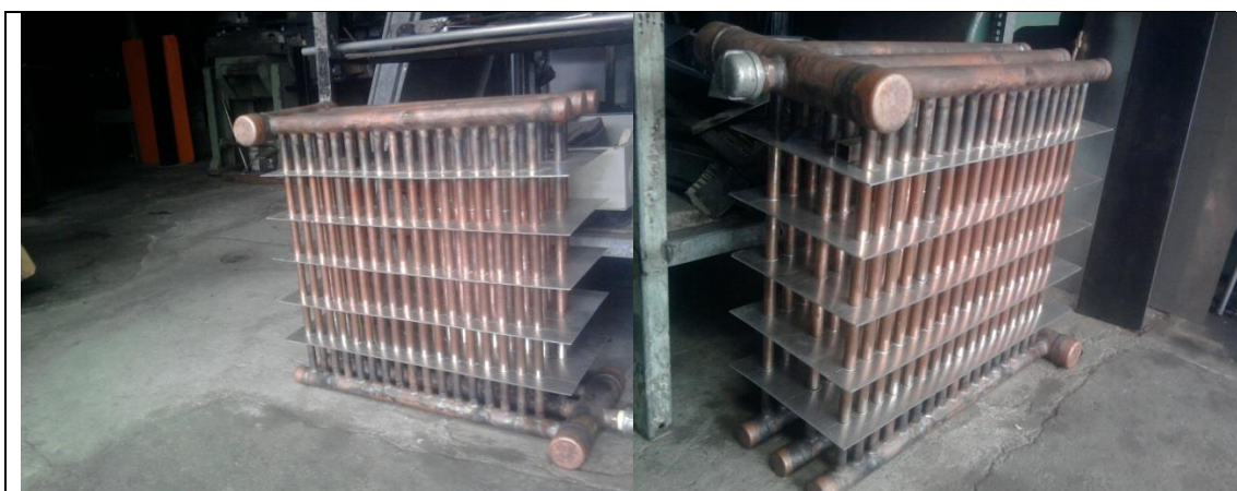
Suelda y colocación de tapones
