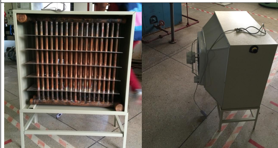
Montaje en estructura y colocación de ventilador
