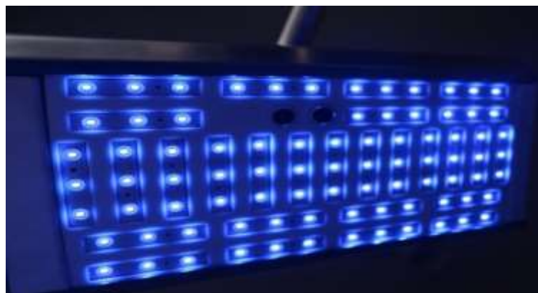
Figura 93. Montaje de luces led y sensor ultrasónico en la carcasa de la lámpara
