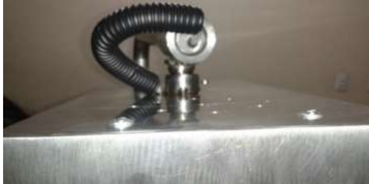
Figura 91. Conexiones eléctricas de la lámpara
