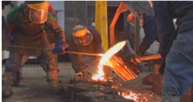
Fig. 2.6.- Colado de hierro gris en Fundireciclar.
