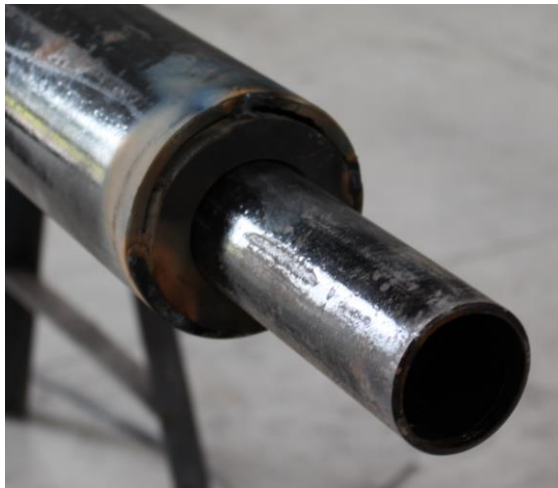
Figura 150. Montaje de tubería interna
