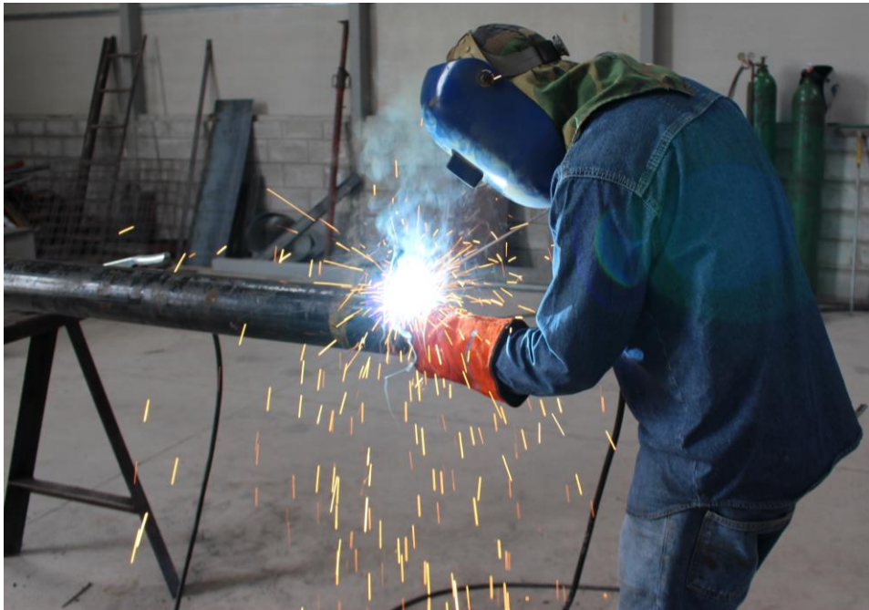
Figura 147. Soldadura de rodela
