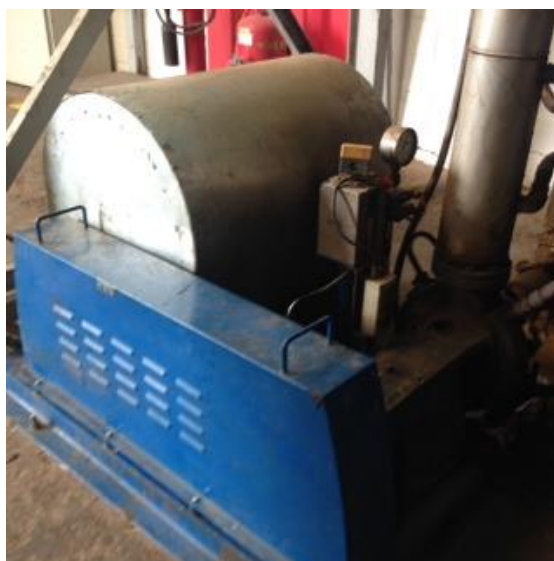
Figura 7. Molino trigonal de recirculación y trituración de asfalto modificado
