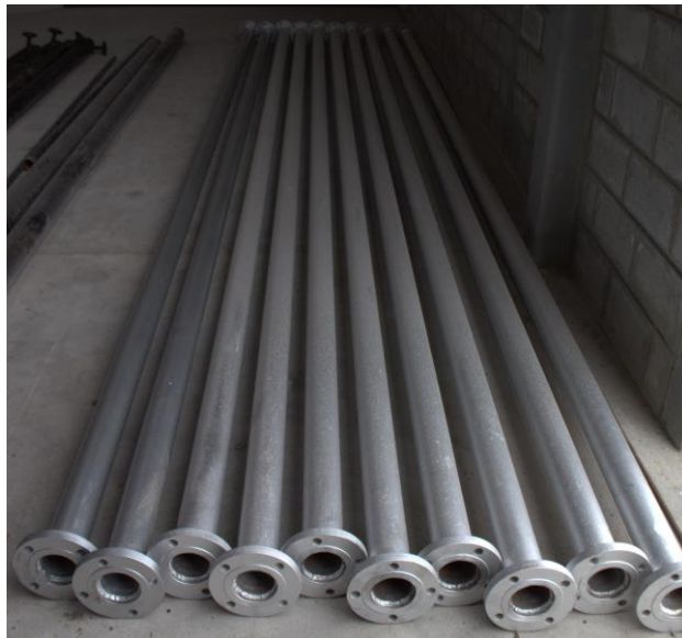
Figura 153. Tuberías de aceite térmico (Sin camisa)
