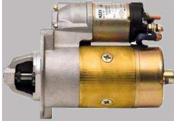
Figura. 3.8. Vista de un arranque típico
