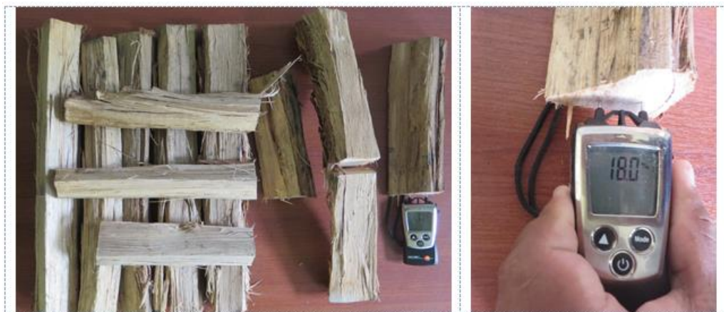
Figura 41. Forma de efectuar las mediciones de humedad en la leña
