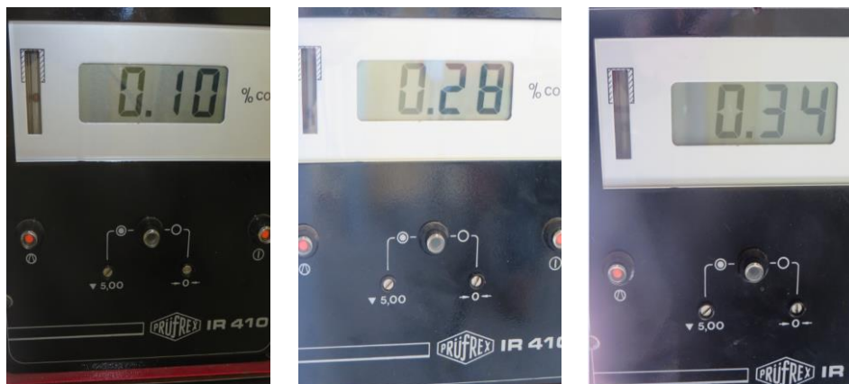
Figura 54. Medición de CO del pino a diferentes humedades sin exceso de aire.
