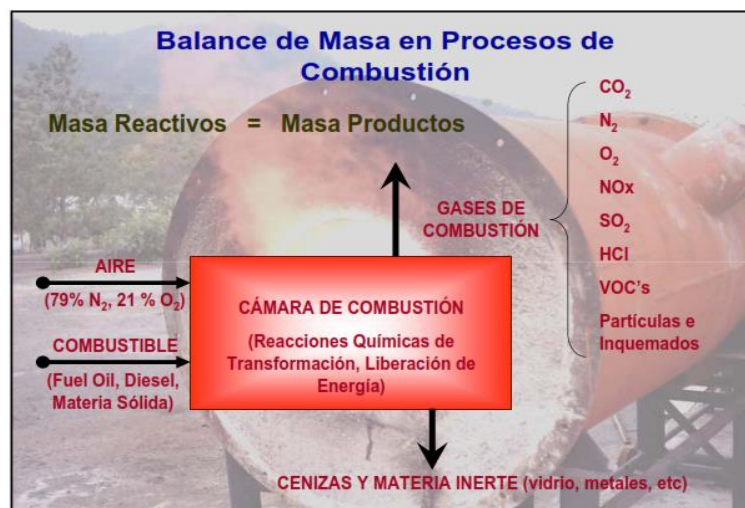
Figura 28. Proceso industrial en cámara combustión
