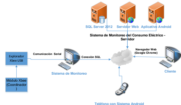
Figura 10. Sistema de Monitoreo del Consumo Eléctrico
