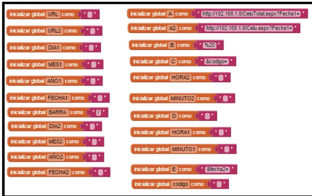
**Figura 68. Programación en bloques inicio de variables a usar**
