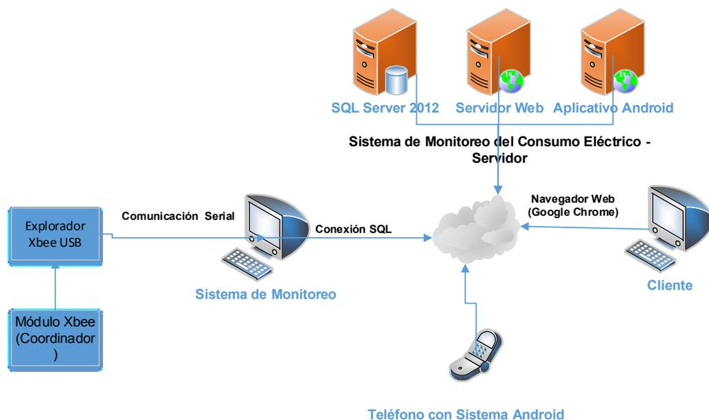
Figura 33. Sistema de Monitoreo del Consumo Eléctrico
