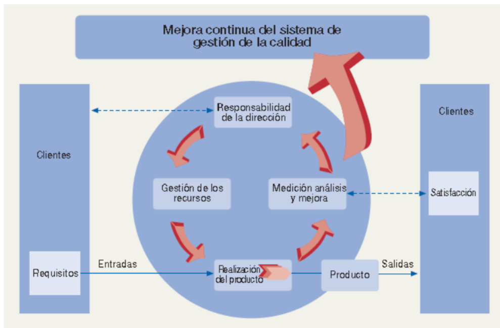
Figura 2-16 Modelo de un Sistema de Gestión de la calidad basado en procesos (Galiano, 2007)
