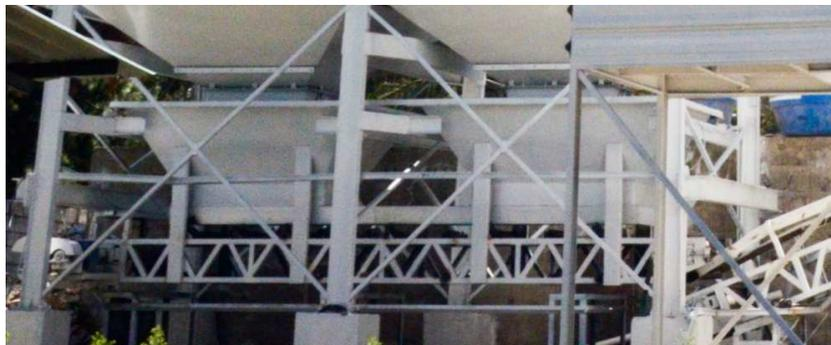
**Figura 8. Tolva de pesaje de agregados**
