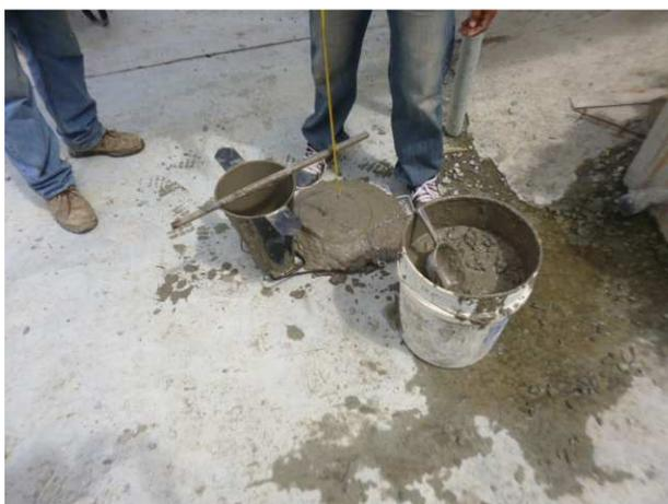
**Figura 135.** Resultado de la prueba de la revenimiento
