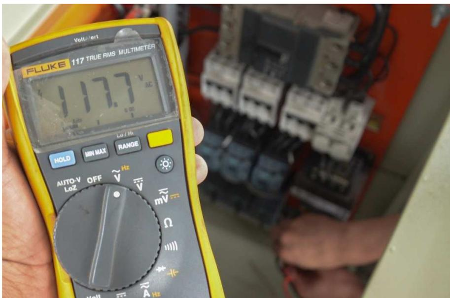
**Figura 124. Medición de voltaje en la línea de alimentación**
