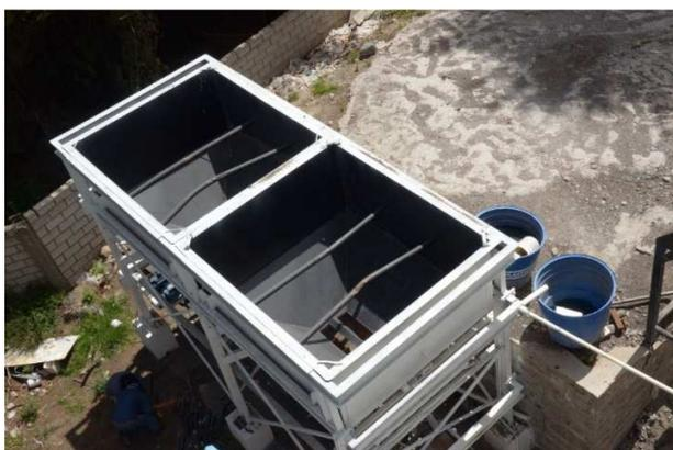
**Figura 6. Tolvas para depósito de agregados**
