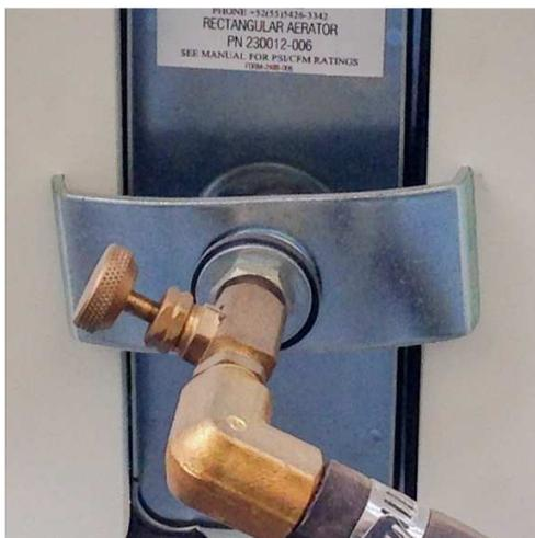
**Figura 41. Aireador o pulmón colocado en uno de los silos**
