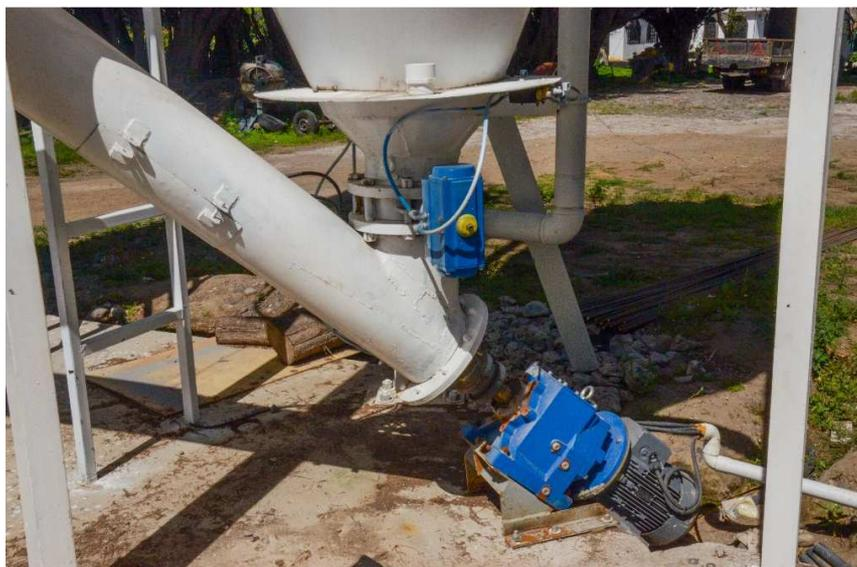
**Figura 21. Mecanismo de activación de los transportadores de tornillo sin fin**
