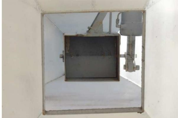
**Figura 10. Mecanismo de apertura de la tolva de pesaje de cemento**
