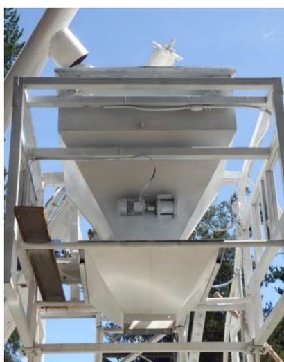
**Figura 9. Tolva de pesaje de cemento**
