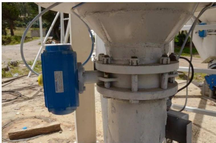
**Figura 13. Mecanismo de apertura de silos**
