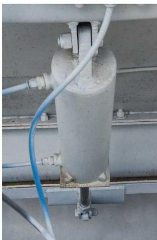
**Figura 39. Cilindro neumático para apertura de tolvas**
