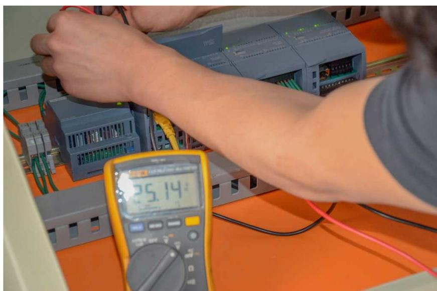
**Figura 125. Medición de voltaje en la fuente de poder**
