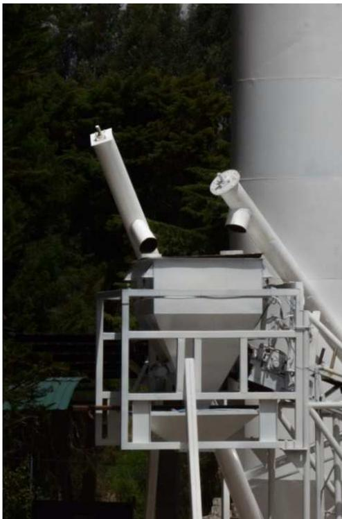
**Figura 20. Transportadores de tornillo sin fin**
