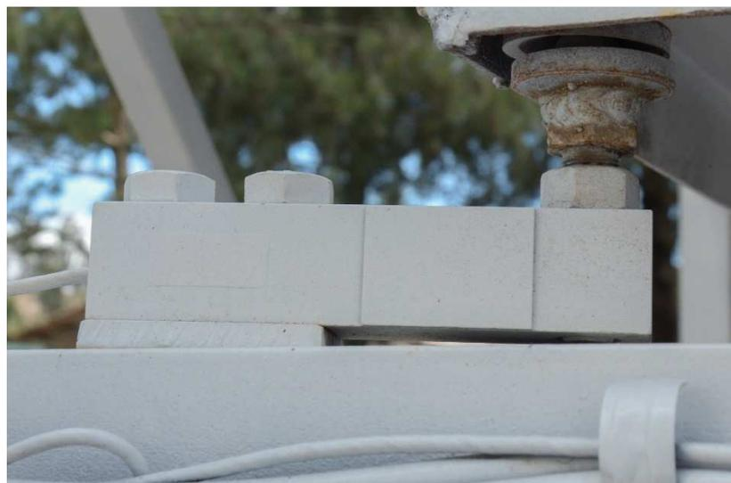
**Figura 35. Celda de carga ubicada en la tolva de pesaje**
