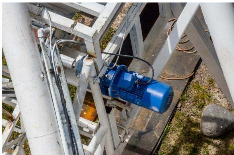
**Figura 19. Mecanismo de activación de la banda rápida**
