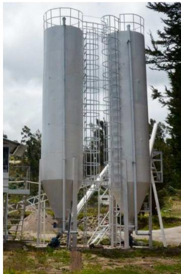
**Figura 11. Silos de cemento en planta dosificadora de hormigón**
