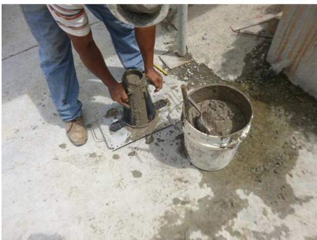
**Figura 134.** Prueba de revenimiento realizada
