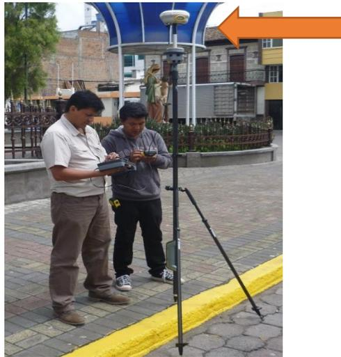
**Figura 89. Posicionamiento del Equipo Trimble V10.**
