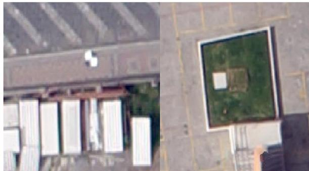
*Figura 9. Ejemplos de Puntos de Control Terrestre.*
