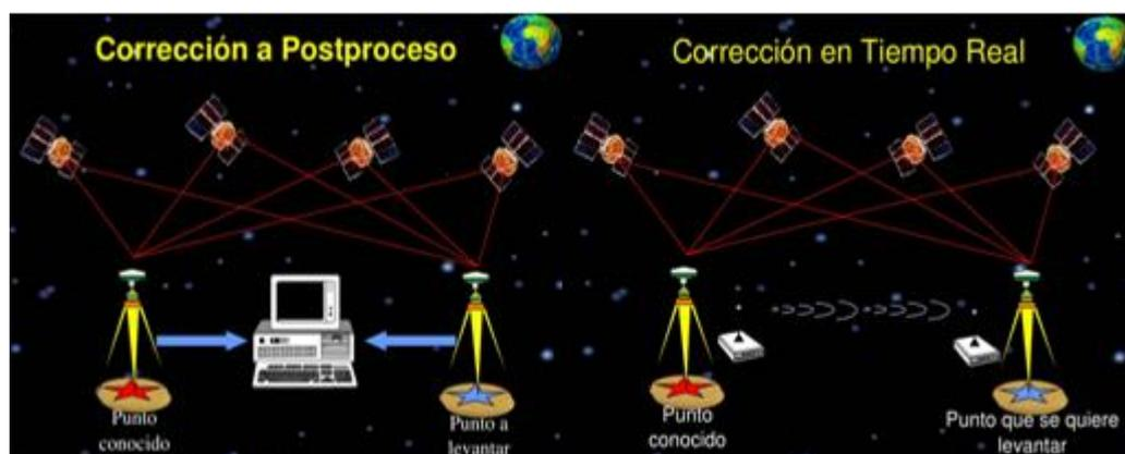
*Figura 11. Posicionamiento estático y RTK.*
