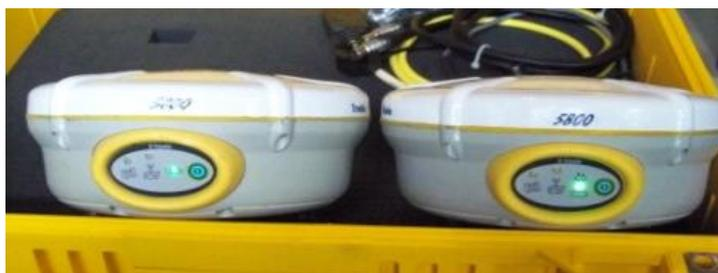
**Figura 56. Antenas Doble Frecuencia Trimble 5800.**
