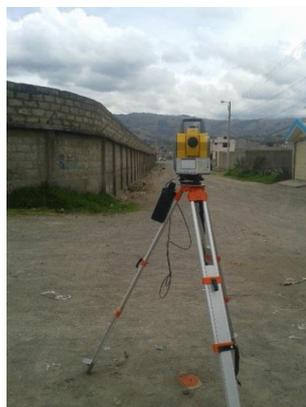
*Figura 111. Estación Trimble 5600.*
